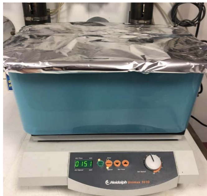
Figura 6: piastra orbitale per la fase dei test di cessione.
