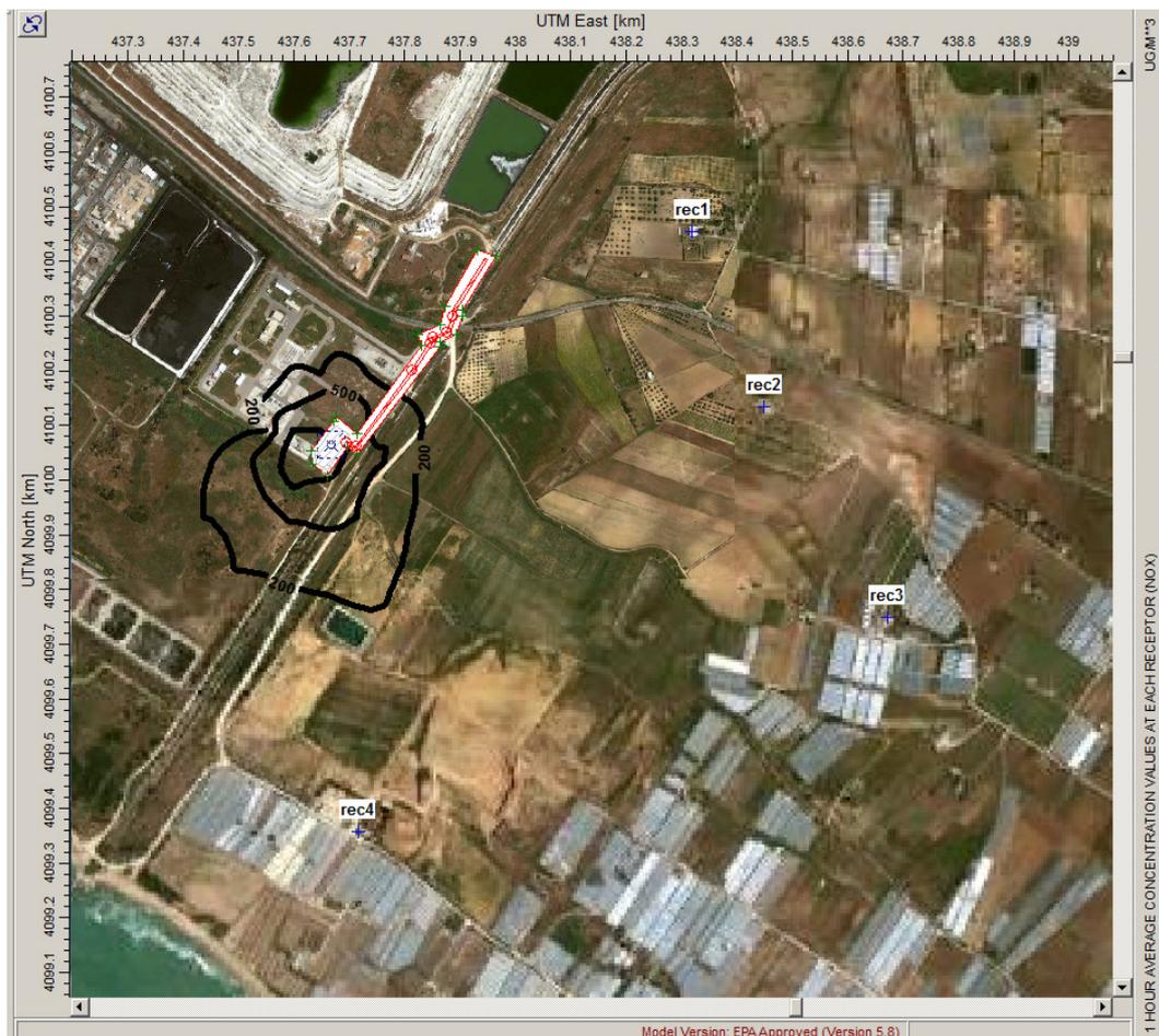
**Figura 5-7: NOx – Valori simulati: massime medie orarie (scenario 3) nell'ipotesi di attività di cantiere continua 365 giorni/anno**
