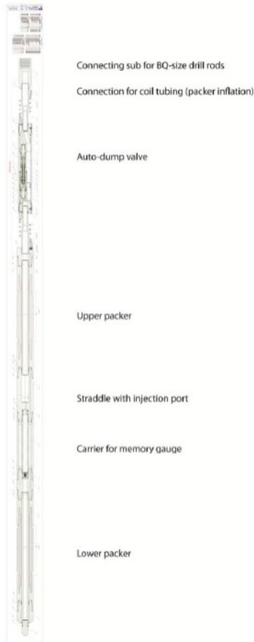
L'acqua per gonfiare i packer e per l'esecuzione della fratturazione idraulica viene pompata attraverso una pompa pneumatica ad alta pressione e controllata da un circuito dotato di manometri in grado di sopportare pressioni di 40MPa.
