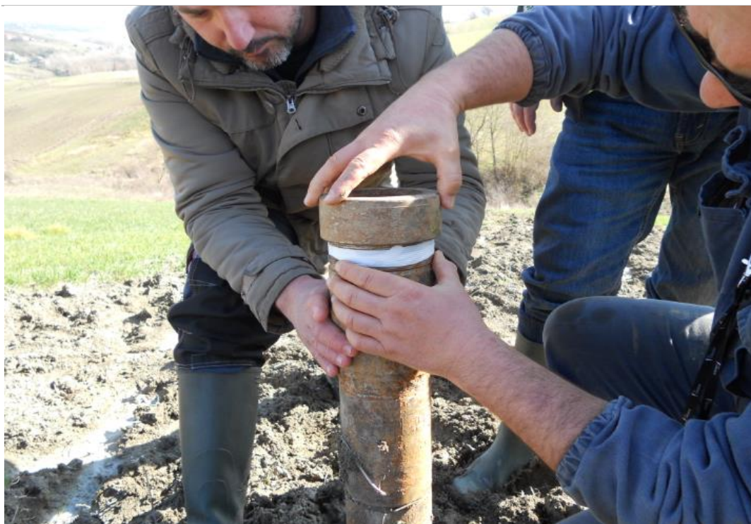
Figura 4.a – 4.b : Preparazione alloggiamento telecamera
