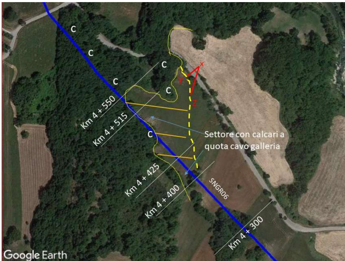
Figura 1-2 – Perforazioni teleguidate alla pk 4+515 della Galleria Grottaminarda
