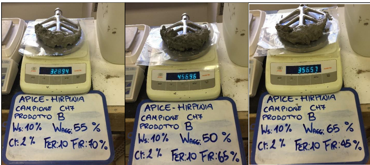
Figura 20 – Risultati delle prove di miscelazione per il litotipo Flysch condizionato con il prodotto HIRPINIA B.
