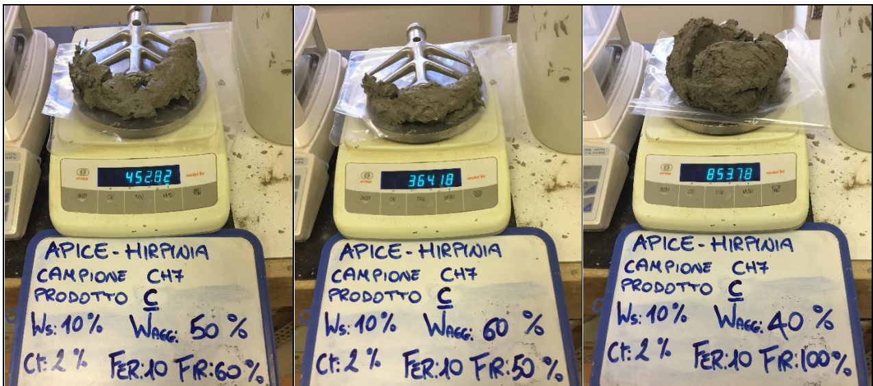
Figura 23 – Risultati delle prove di miscelazione e di pull-out per il Flysch condizionato con il prodotto HIRPINIA C.
