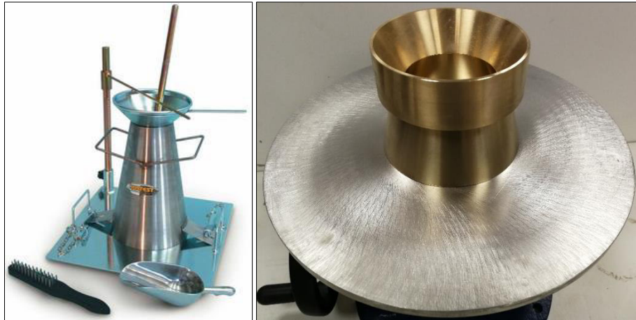
Figura 12 – Cono di Abrams e tavola a scosse utilizzati per le prove di laboratorio.
