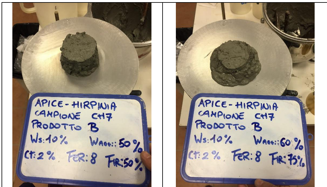
Figura 21 – Fotografie delle palette dell’Hobart mixer e delle prove di flow table test al termine di alcune delle prove di laboratorio eseguite su campioni di Flysch condizionato con prodotto HIRPINIA B.
