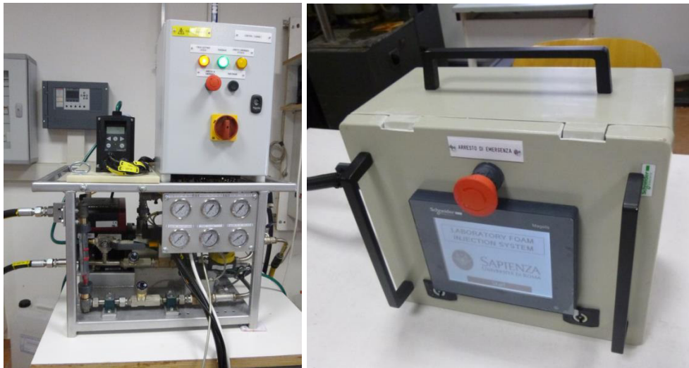
Figura 3 - Generatore di schiuma messo a punto presso il Dipartimento di Ingegneria Strutturale e Geotecnica (DISG) dell'Università di Roma "Sapienza".
