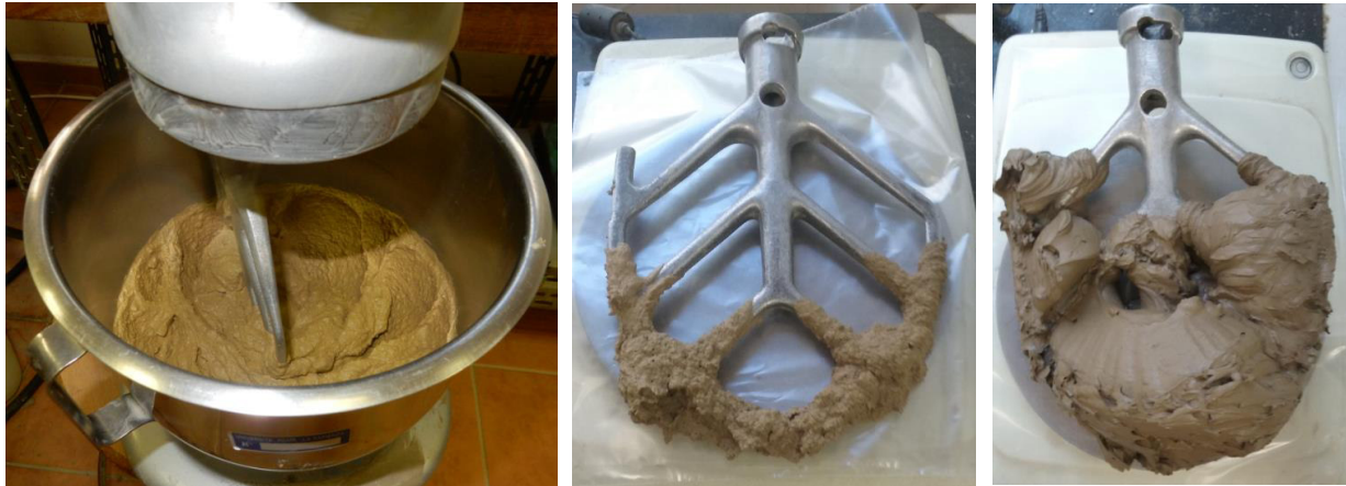
Figura 15 –Mixer Hobart e rappresentazione dei risultati con un campione di terreno ben condizionato e non correttamente condizionato.
