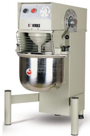
Figura 16 – Miscelatore da laboratorio utilizzato per il condizionamento dei terreni per le prove di laboratorio.
