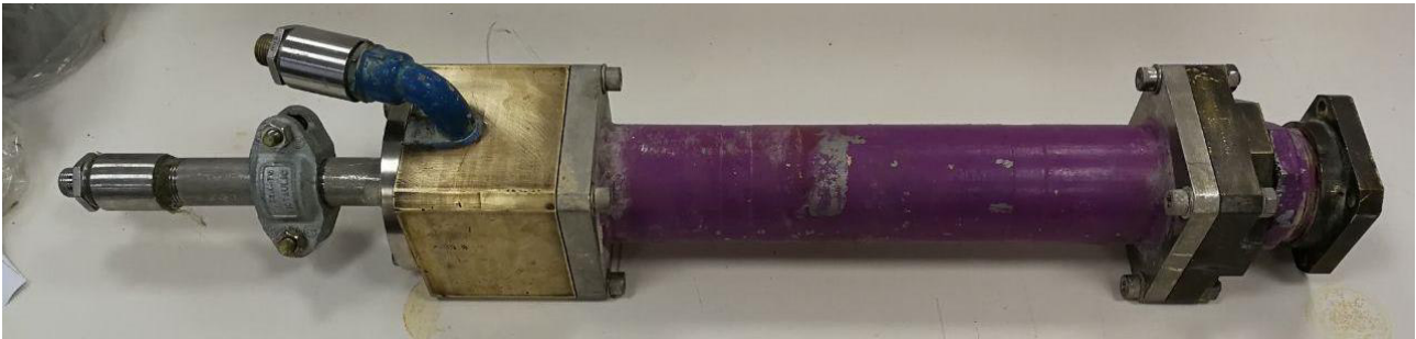
Figura 4 – Lancia di generazione della schiuma disponibile presso il Dipartimento di Ingegneria Strutturale e Geotecnica (DISG) della Sapienza utilizzata per la sperimentazione.
