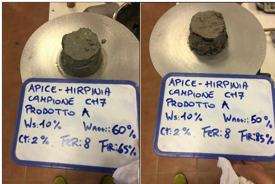
Figura 18 – Fotografie delle palette dell’Hobart mixer e delle prove di flow table test al termine di alcune delle prove di laboratorio eseguite su campioni di Flysch condizionato con prodotto HIRPINIA A.
