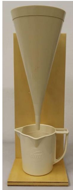
Figura 5 – Cono di Marsh per la determinazione della viscosità dei prodotti.
