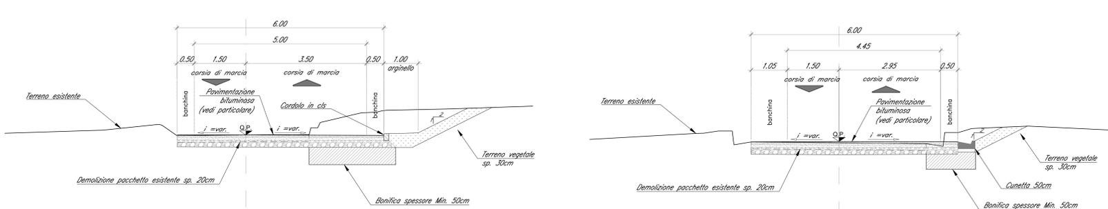
Particolare arginello in rilevato
