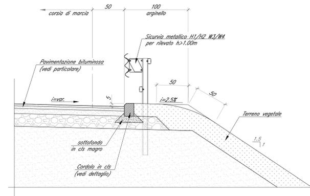
Particolare pavimentazione bituminosa
