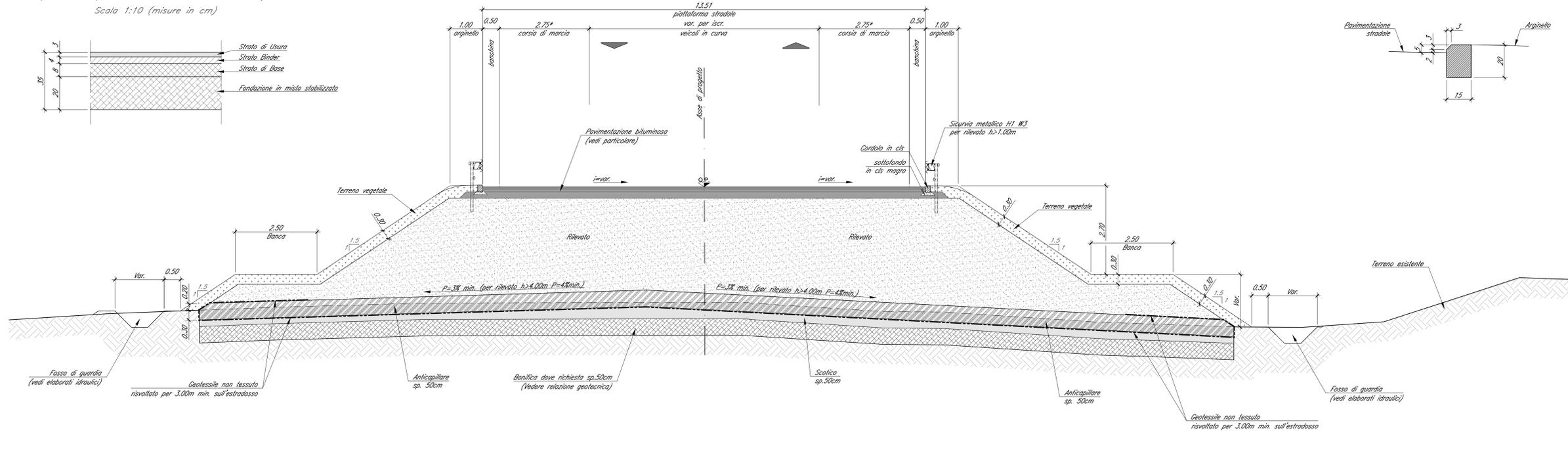
Sezione Tipo in rilevato
