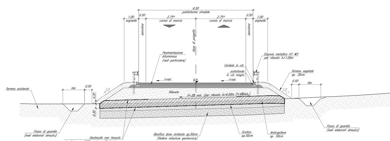
Particolare arginello in rilevato
