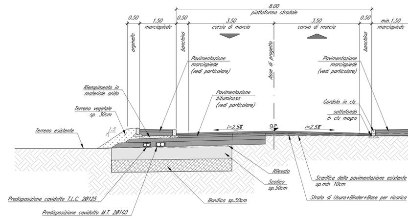
Sezione Tipo in rilevato
