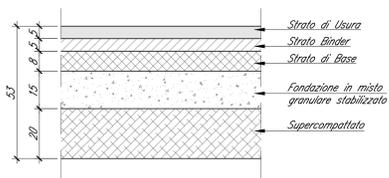
Particolare pavimentazione bituminosa
