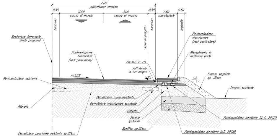
Particolare pavimentazione bituminosa
