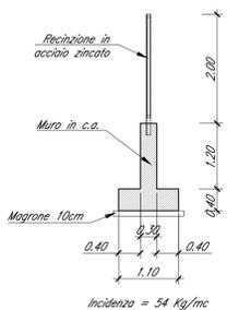
Sezione Tipo con muro di recinzione
