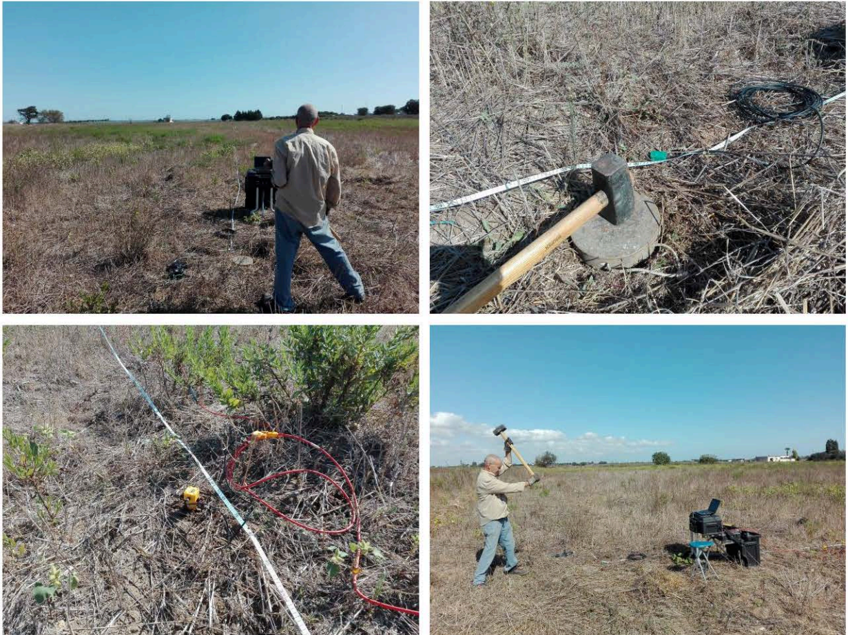
Fig. 8.4.3: Documentazione fotografica Indagini Sismiche Re.Mi.-MASW
