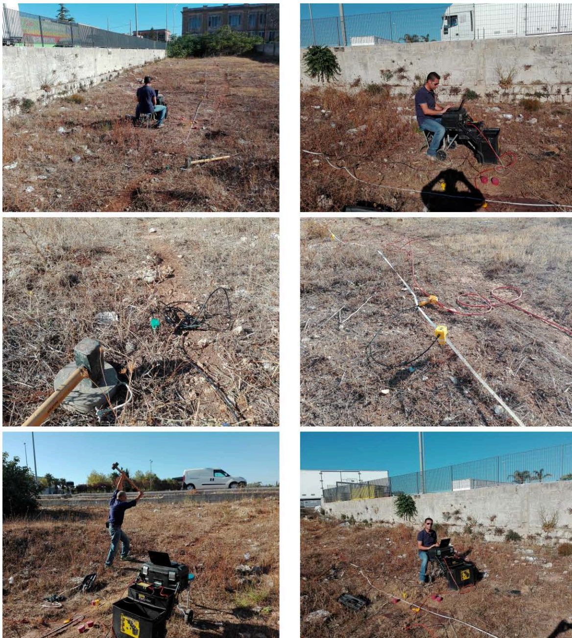
Fig. 8.4.1: Documentazione fotografica Indagini Sismiche Re.Mi.-MASW
