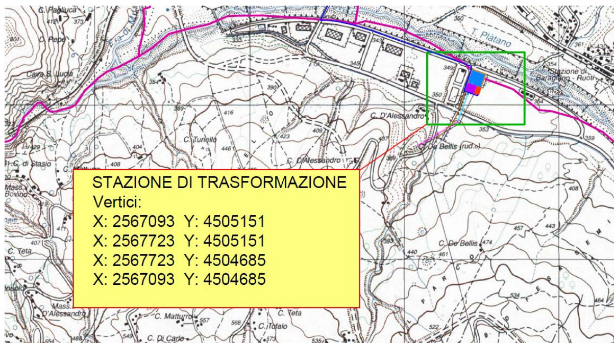
Figura 8: -- Inquadratura dell'area su cui è prevista la Sottostazione elettrica (IGM 1:25000), con indicazione dei vertici del poligono che la delimita (cfr. tav. A.16.a.5)
