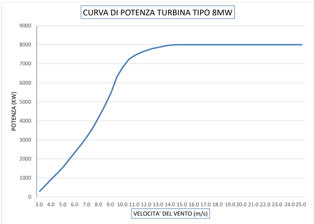
*Curva di potenza aerogeneratore tipo*
