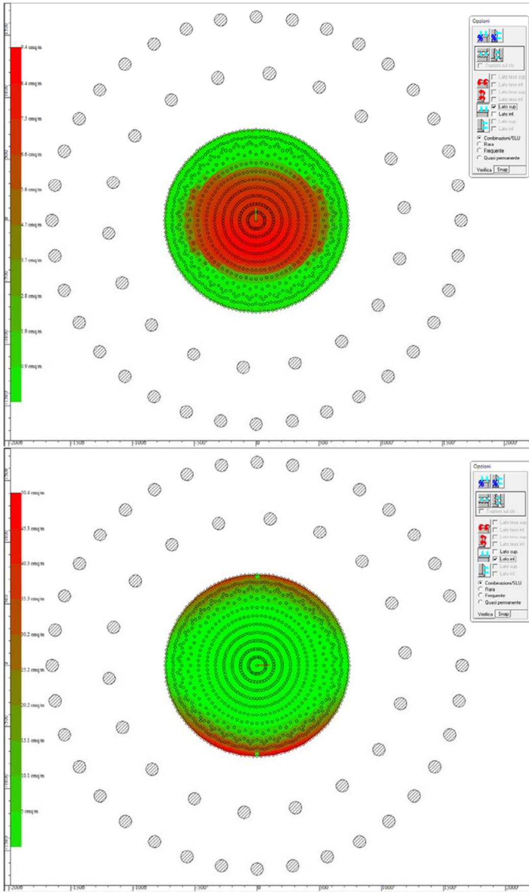
Fig. 9.11: Area minima di ferri verticali superiori e inferiori Zona 6
