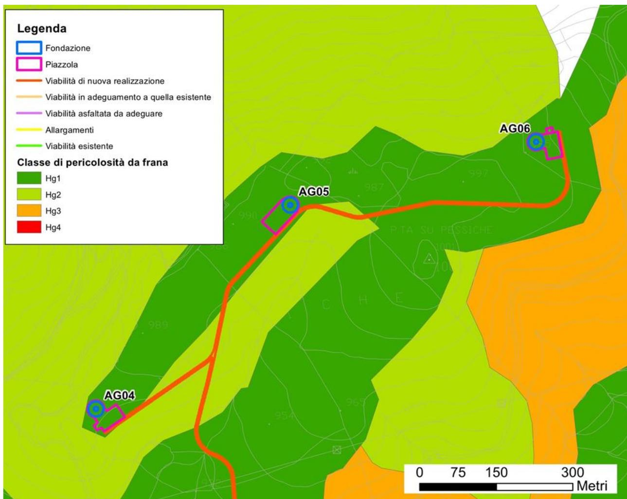
Figura 3.6 – Sovrapposizione della viabilità d'accesso alle postazioni Ag04 e Ag05 con aree a pericolosità da frana Hg2 - Media
