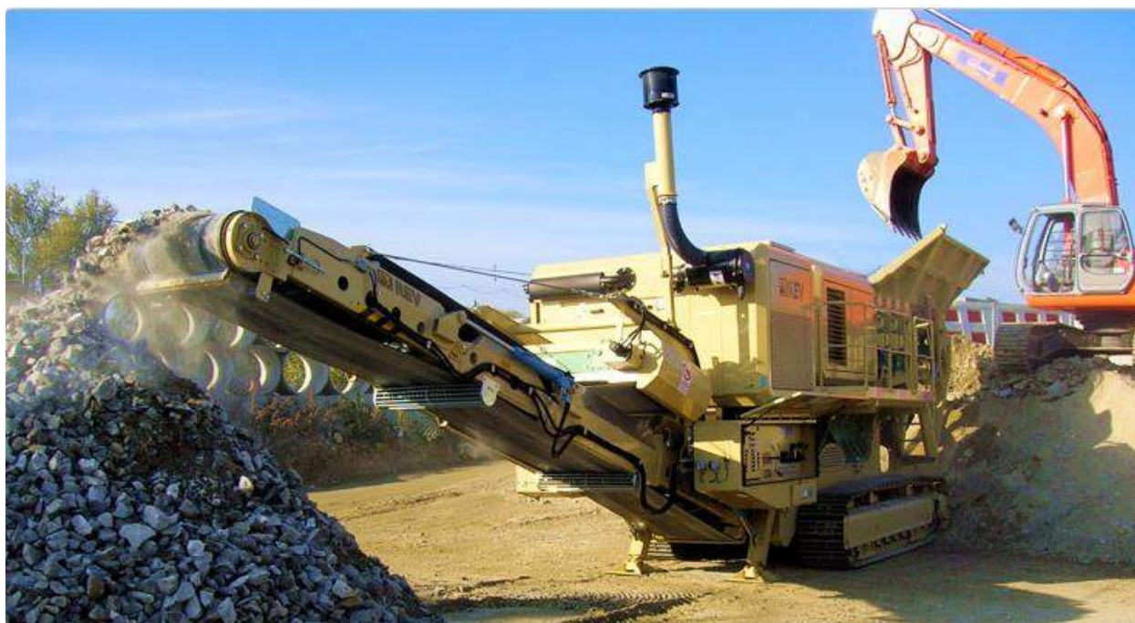
Figura 5.18 – Tipico frantoio mobile per il riutilizzo in sito delle rocce da scavo
