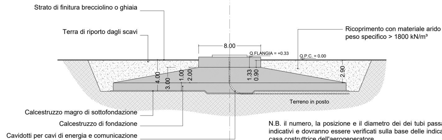
N.B. il numero, la posizione e il diametro dei dei tubi passacavi sono indicativi e dovranno essere verificati sulla base delle indicazioni della casa costruttrice dell'aerogeneratore
