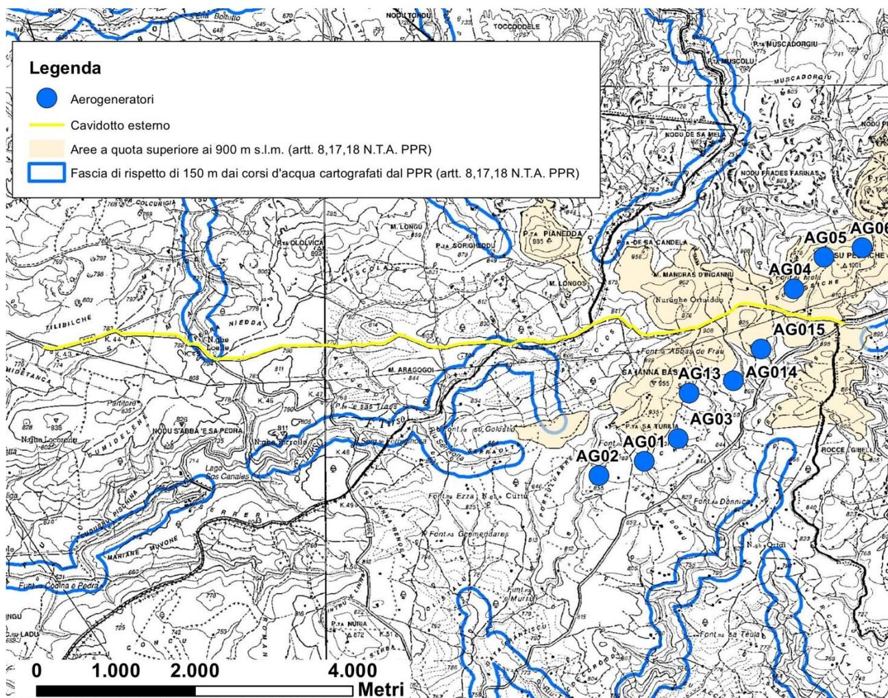
Figura 9.14 – Sovrapposizione del tracciato del cavidotto dorsale MT con aree a quota superiore 900m e con la fascia di tutela dei corsi d'acqua cartografati dal PPR
