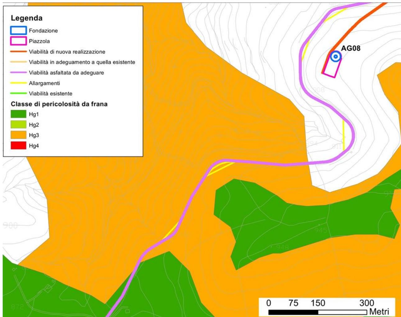
Figura 11.3 – Sovrapposizione di una porzione della viabilità in calcestruzzo da adeguare, nonché di due allargamenti, con aree a pericolosità da frana Hg3 - Elevata
