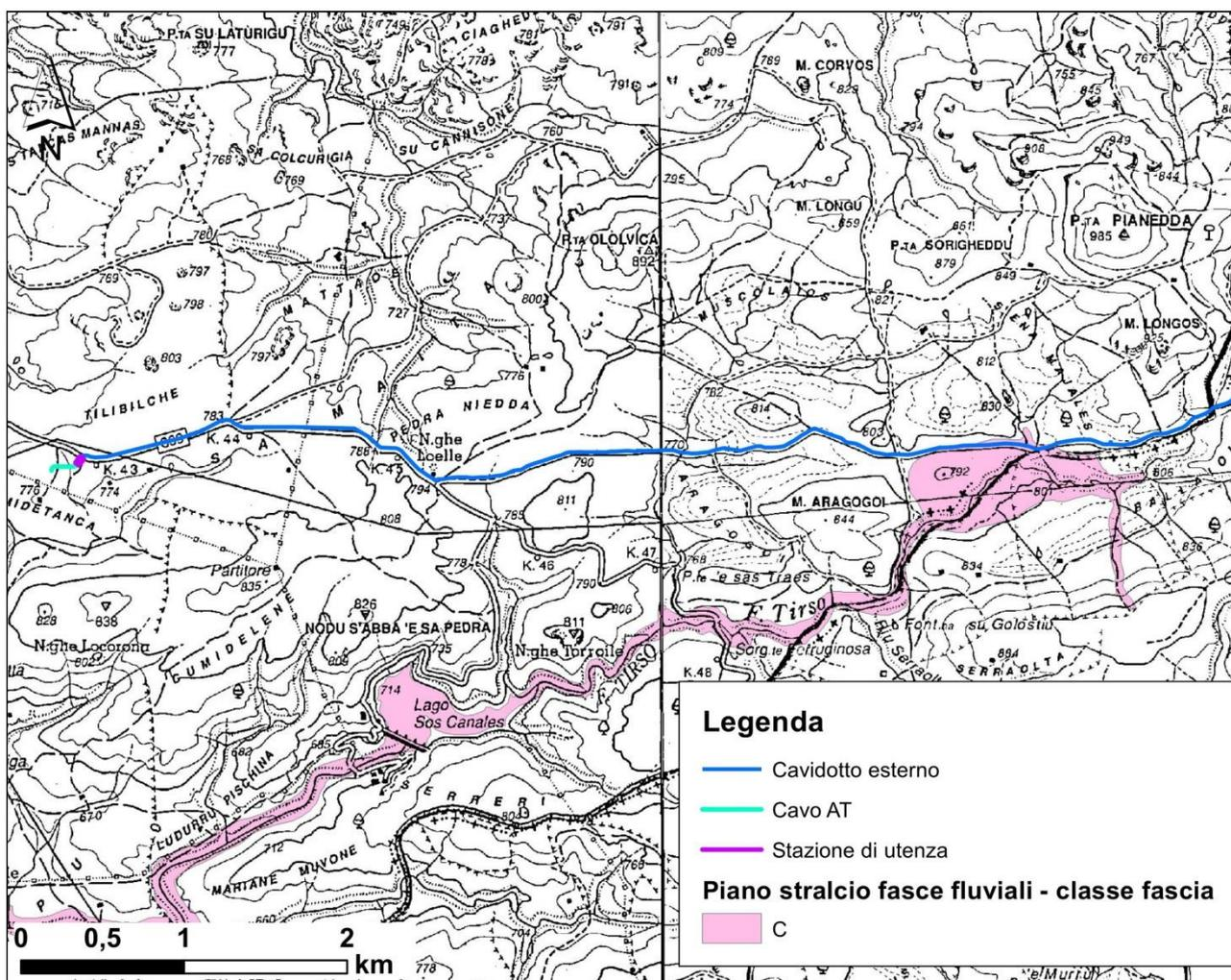
Figura 11.4 – Aree a pericolosità idraulica mappata dal PSFF (2015) in corrispondenza del tracciato del cavidotto MT
