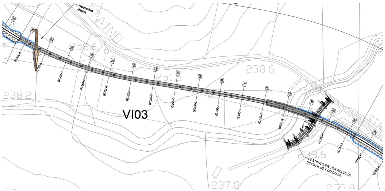
Figura 5 – Corso d'acqua minore alla pk 3+100 (bacino ID = 8): attraversamento in progetto (viadotto VI03).
