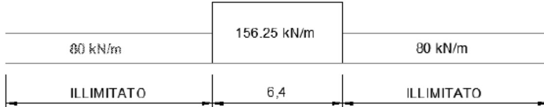
Mentre in direzione trasversale la diffusione dei carichi attraverso Ballast avviene con pendenza 1:4, attraverso il ricoprimento con angolo di attrito mentre, nella soletta in cls con pendenza 1:1. Quindi il carico equivalente a livello dell'asse della soletta risulta pari a:
