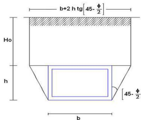
Più in dettaglio Terzaghi fornisce due espressioni differenti della pressione a seconda della maggiore o minore altezza del ricoprimento,  $H_0$ .
