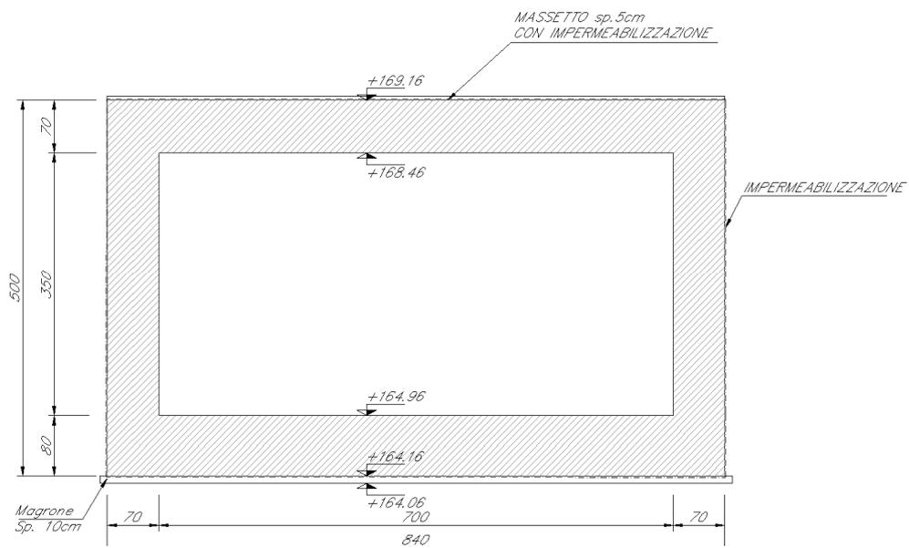
Figura 2 – Sezione trasversale B-B
