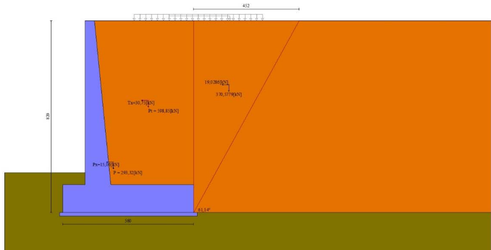
Fig. 5 - Cuneo di spinta (combinazione sismica) (Combinazione n° 2)
