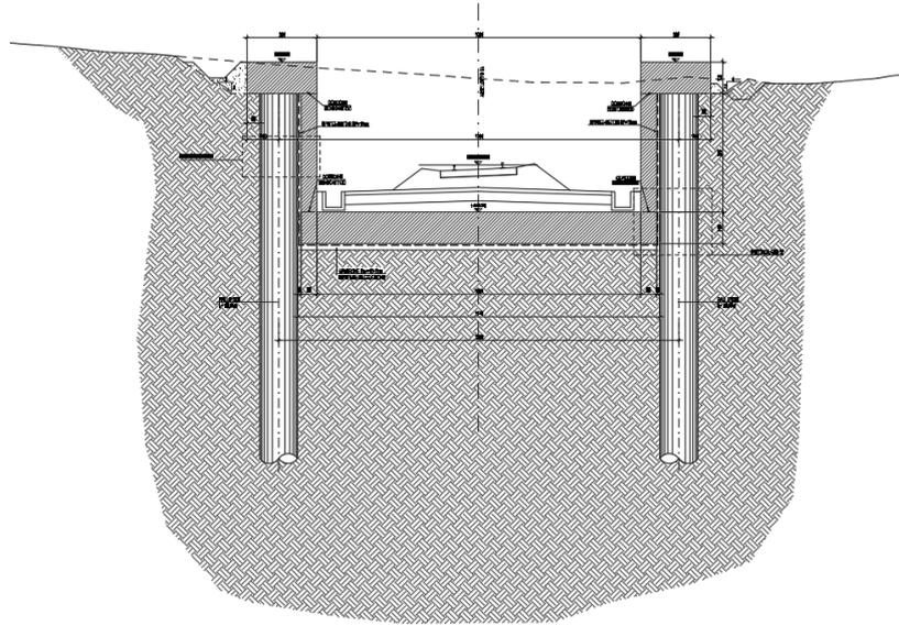
**Fig. 1** – Sezione trasversale dell'opera TR07
