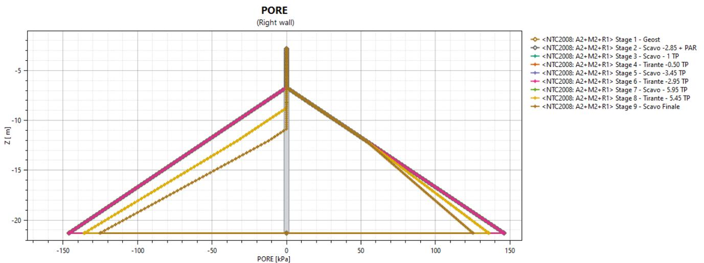
**Figura 12: Tensioni pressioni neutre allo SLU (A2-M2-R1)**
