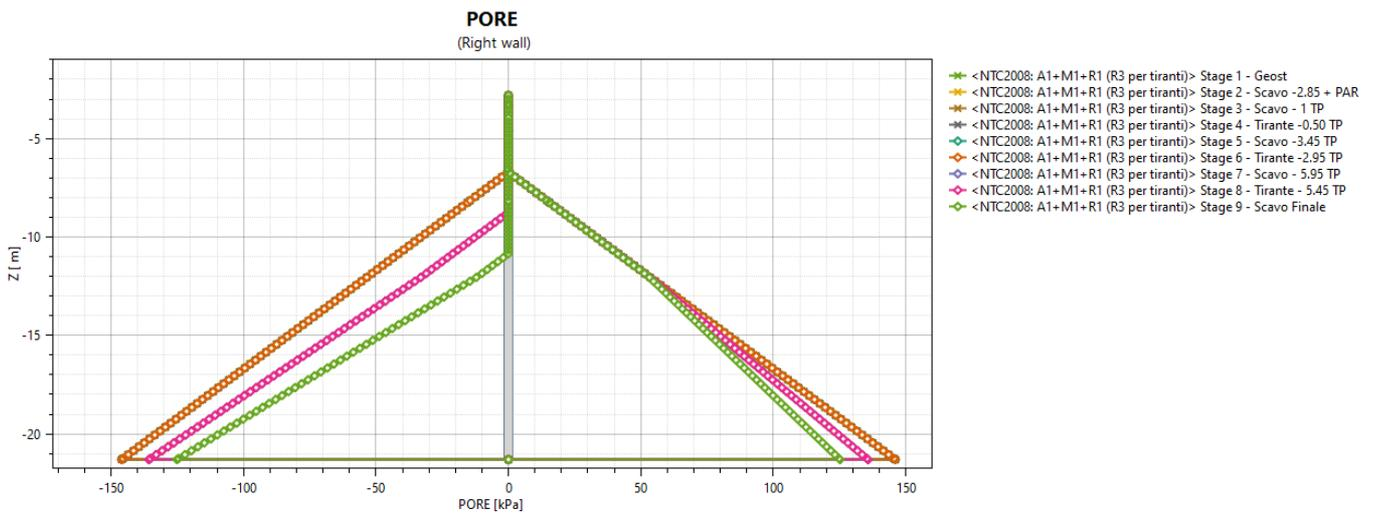
**Figura 10: pressioni neutre allo SLU (A1-M1-R1)**
