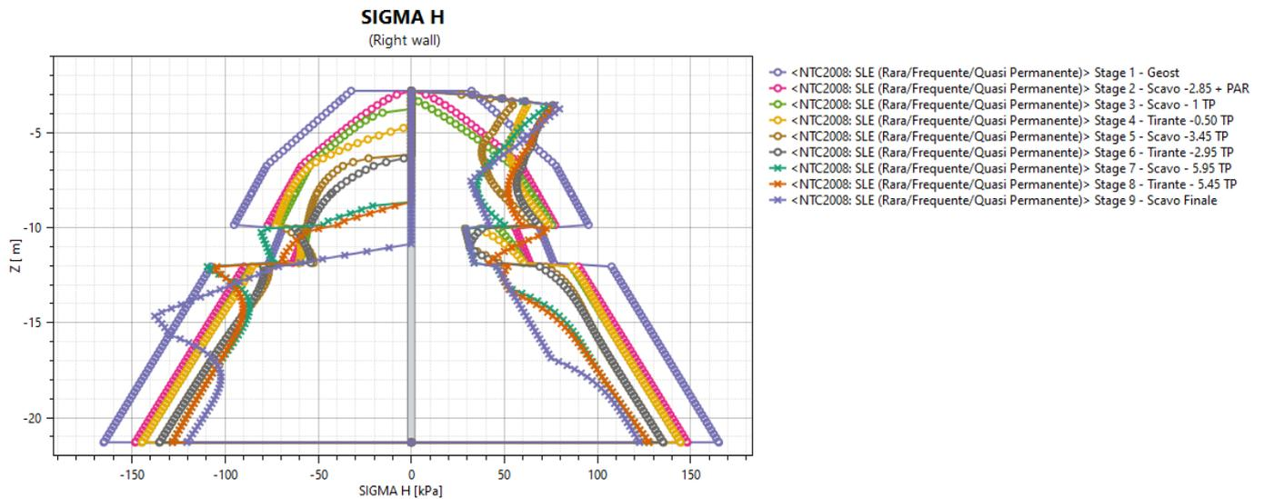
**Figura 7: Tensioni orizzontali allo SLE**
