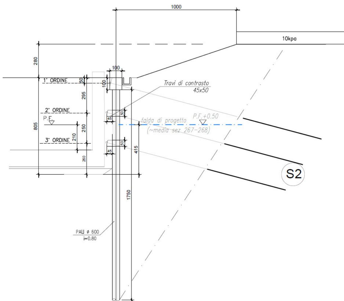
La sezione di calcolo fa riferimento alla condizione di altezza massima riscontrabile per la tipologia in esame a cavallo della sezione di progetto n 267; il livello di falda di progetto è infine assunto all'incirca pari al valore medio tra le sezioni n267-268.
