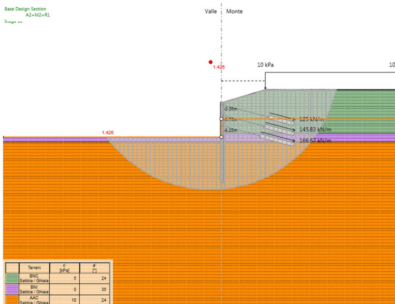
Figura 13: Superficie di scorrimento critica Cond. Statica (A2-M2).--- F.S=1.426 >1.1. Verifica soddisfatta
