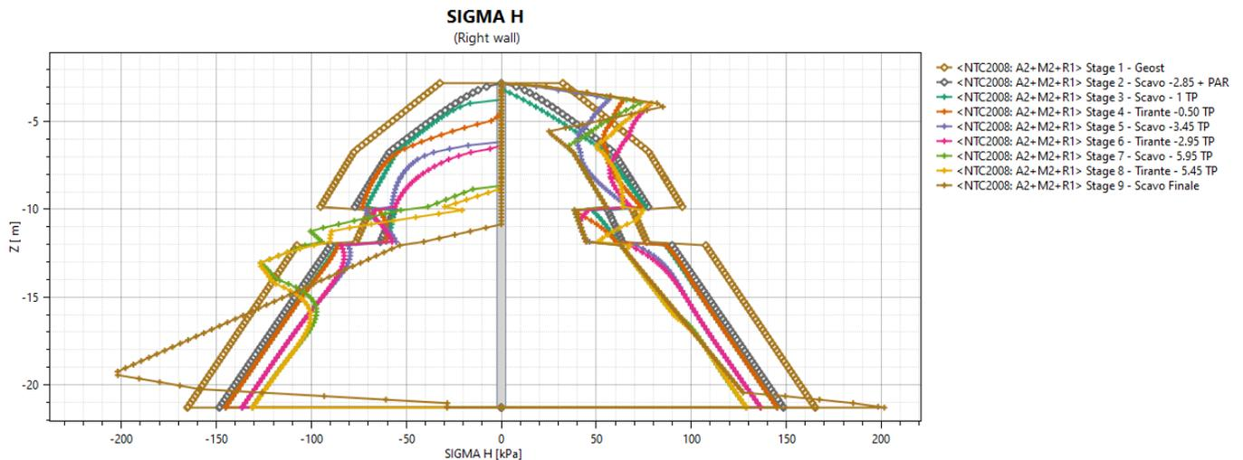
**Figura 11: Tensioni orizzontali allo SLU (A2-M2-R1)**
