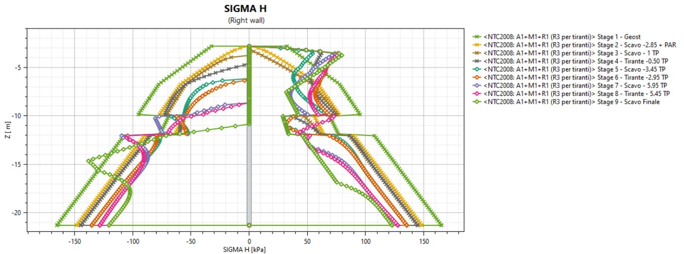
**Figura 9: Tensioni orizzontali allo SLU (A1-M1-R1)**
