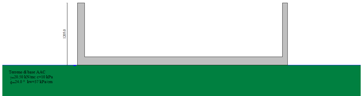
Modello Geotecnico di Riferimento (quote in cm)
