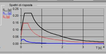
— Spettro di progetto - componente orizzontale
