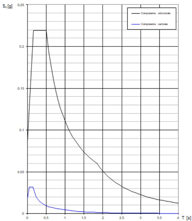
Spettro di progetto inelastico
