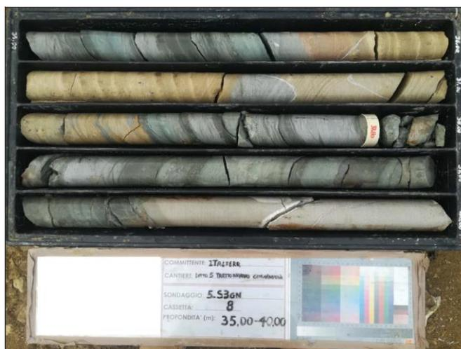
Figura 41 Formazione di Catenanuova – Litofacies AACa – Foro di sondaggio 5\_S3gn, tra i 35 ed i 40 m da p.c.
