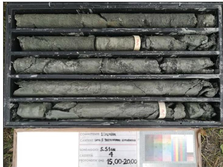
**Figura 8 - Formazione di Terravecchia – Litofacies TRV – Foro di sondaggio 5\_S1gn, tra i 15 ed i 20 m da p.c.**
