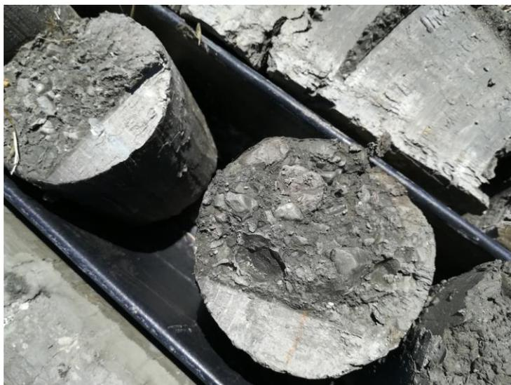
**Figura 18 Formazione Terravecchia – Litofacies TRVb - Dettaglio della struttura brecciata**
