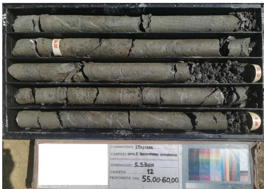
Figura 32 Formazione di Catenanuova – Litofacies AAC – Foro di sondaggio 5\_S3gn, tra i 55 ed i 60 m da p.c.
