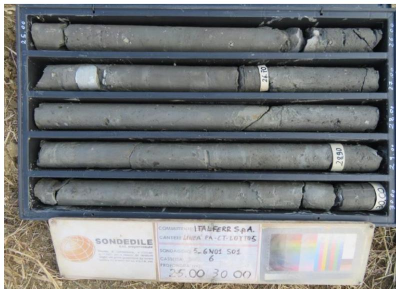
**Figura 17 - Formazione Terravecchia – Litofacies TRVb - Foro di sondaggio 5GN01, tra 25 e 30 m da p.c.**
