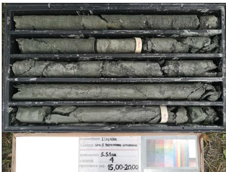
Figura 3 - Formazione di Terravecchia – Litofacies TRV – Foro di sondaggio 5_S1gn, tra i 15 ed i 20 m da p.c.
