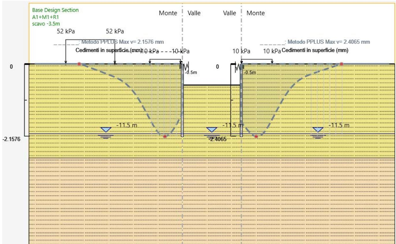
In particolare per la sezione di calcolo il cedimento assoluto in corrispondenza della rotaia più vicina è pari a 0.15 mm mentre per la sezione posta a 3m di distanza i cedimenti assoluti in corrispondenza delle rotaie sono 0.06 mm e con cedimento differenziale  $\delta$  pari a 0.09 mm. Pertanto risulta verificato il valore limite di 3mm/3m imposto dalla NTC.
