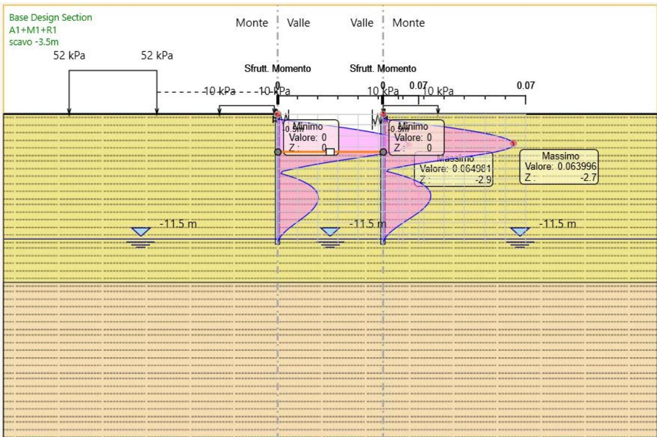
Tasso di sfruttamento a taglio nelle palancole metalliche in comb. A1-M1-R3 ( $T.S.F._{max} = 0.037 < 1$  – VERIFICA SODDISFATTA)
