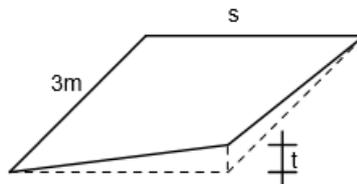
**Figura 5.2.14 - Sghembo ammissibile**
