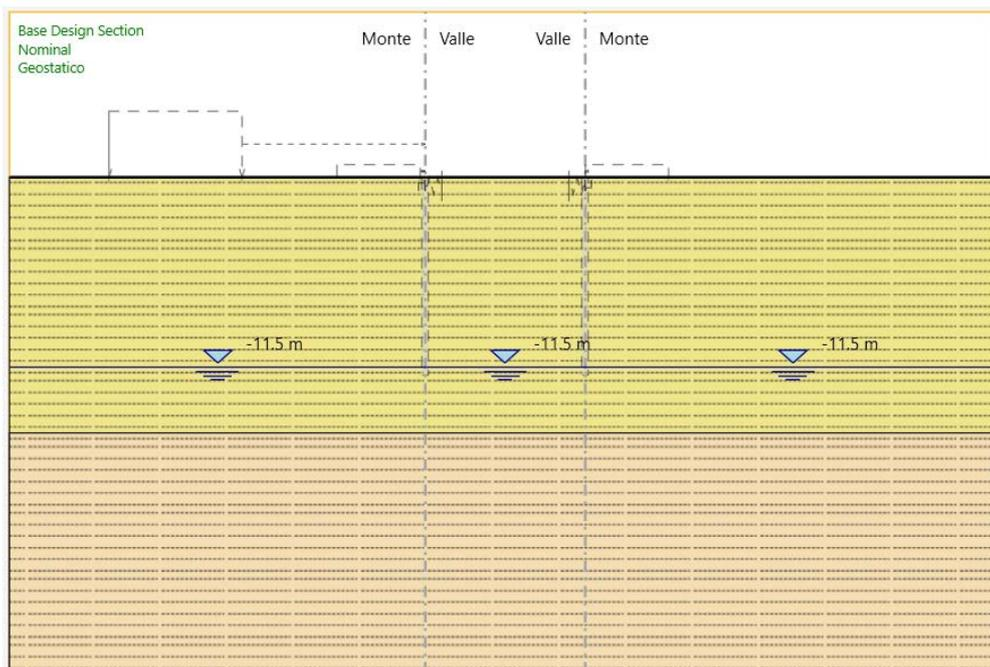
**FASE 1: Installazione delle palancole metalliche + attivazione carico di cantiere  $q_{acc} = 10.0 \text{ kPa}$  + attivazione carico da sovraccarico ferroviario  $q = 52 \text{ kPa}$  dovuto alle vicinanze della linea storica**
