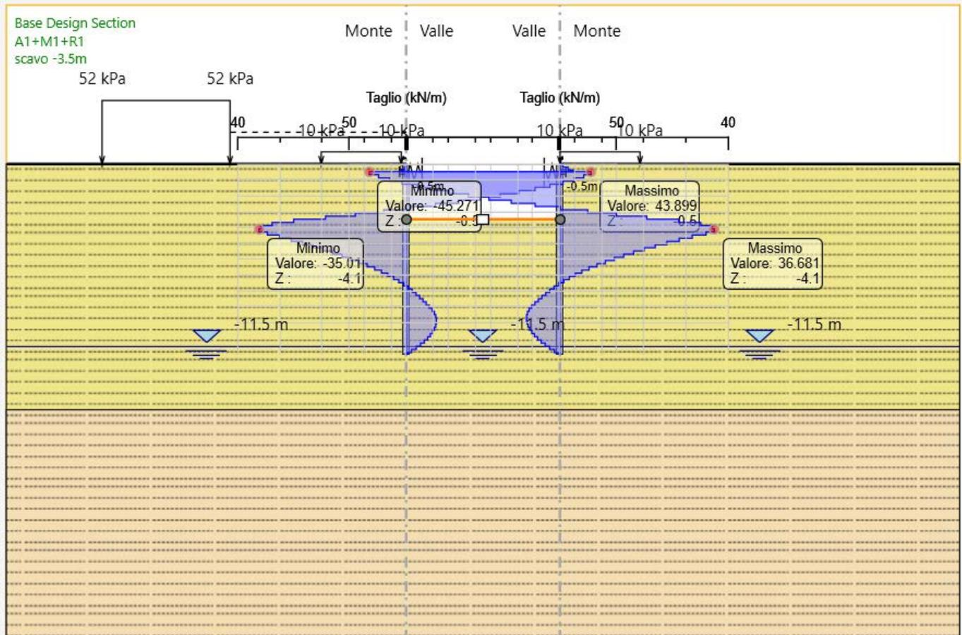
Nel seguito si riportano i risultati delle verifiche strutturali delle palancole metalliche a flessione e a taglio condotte mediante l'ausilio di Paratie plus. In Particolare si riportano i diagrammi dei tassi di sfruttamento sulle palancole, ottenuti come rapporto tra sollecitazione presente e resistenza disponibile in ogni sezione delle palancole.
