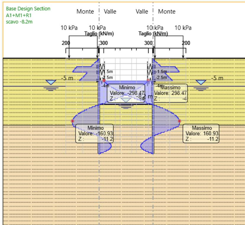
Nel seguito si riportano i risultati delle verifiche strutturali delle palancole metalliche a flessione e a taglio condotte mediante l'ausilio di Paratie plus. In Particolare si riportano i diagrammi dei tassi di sfruttamento sulle palancole, ottenuti come rapporto tra sollecitazione presente e resistenza disponibile in ogni sezione delle palancole.
