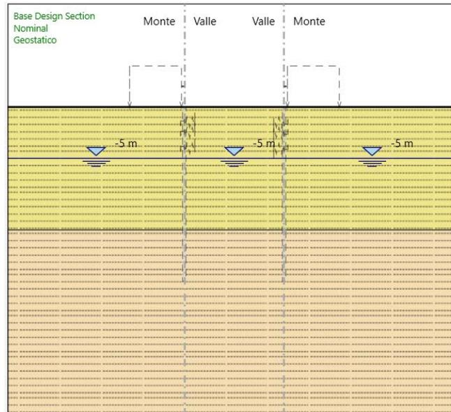
**FASE 1: Installazione delle palancole metalliche + attivazione carico di cantiere qacc = 10.0 kPa**
