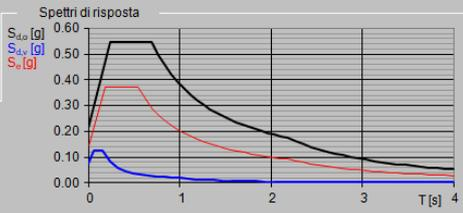
— Spettro di progetto - componente orizzontale
