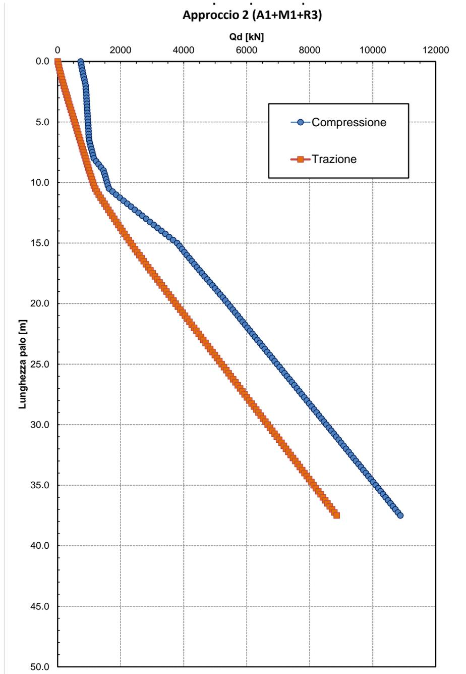
**Figura 1 – Capacità portante palo D=1500 mm**
