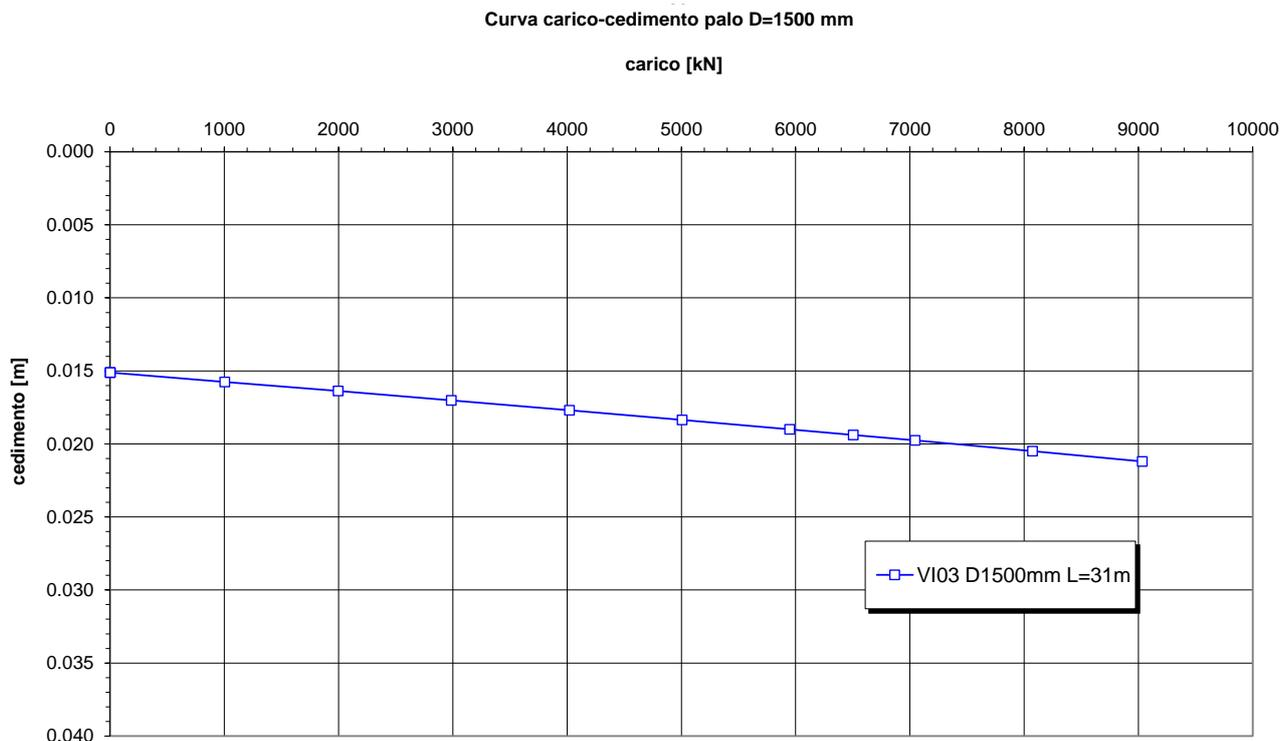
**Figura 2 – Curva carico-cedimento in presenza di attrito negativo**
