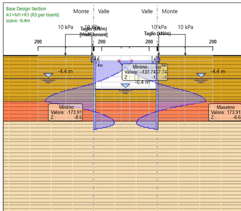
Nel seguito si riportano i risultati delle verifiche strutturali delle palancole metalliche a flessione e a taglio condotte mediante l'ausilio di Paratie plus. In Particolare si riportano i diagrammi dei tassi di sfruttamento sulle palancole, ottenuti come rapporto tra sollecitazione presente e resistenza disponibile in ogni sezione delle palancole.
