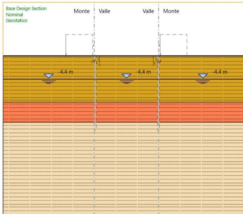
**FASE 1: Installazione delle palancole metalliche + attivazione carico di cantiere qacc =10.0 kPa+attivazione carico che simula terreno**
