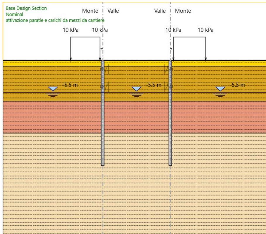
**FASE 1: Installazione delle paratie di pali + attivazione carico di cantiere qacc=10.0 kPa**
