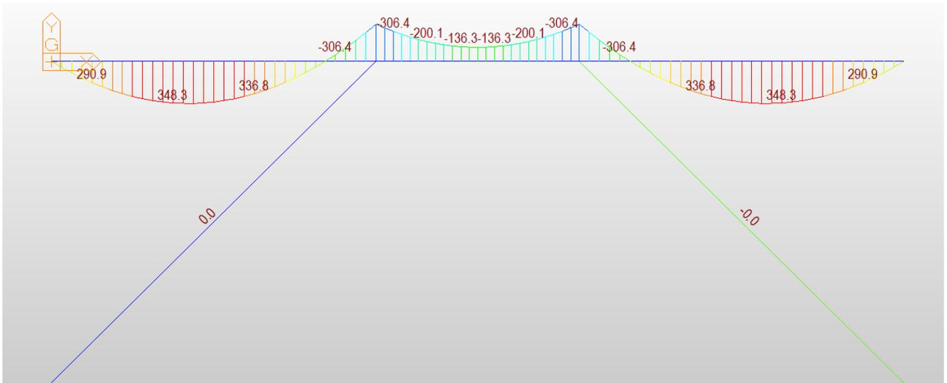
La resistenza di calcolo a flessione retta della sezione  $M_{c,Rd}$  vale per le sezioni di classe 1 e 2
