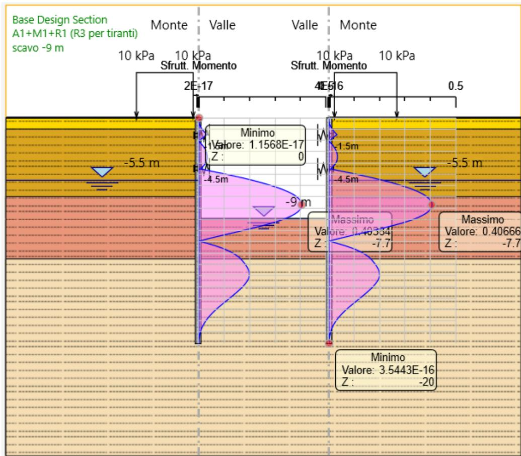
Tasso di sfruttamento a taglio nelle palancole metalliche in comb. A1-M1-R3 ( $T.S.F._{max} = 0.45 < 1$  - VERIFICA SODDISFATTA)
