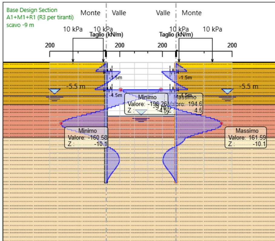
Nel seguito si riportano i risultati delle verifiche strutturali delle palancole metalliche a flessione e a taglio condotte mediante l'ausilio di Paratie plus. In Particolare si riportano i diagrammi dei tassi di sfruttamento sul palo, ottenuti come rapporto tra sollecitazione presente e resistenza disponibile in ogni sezione del palo.
