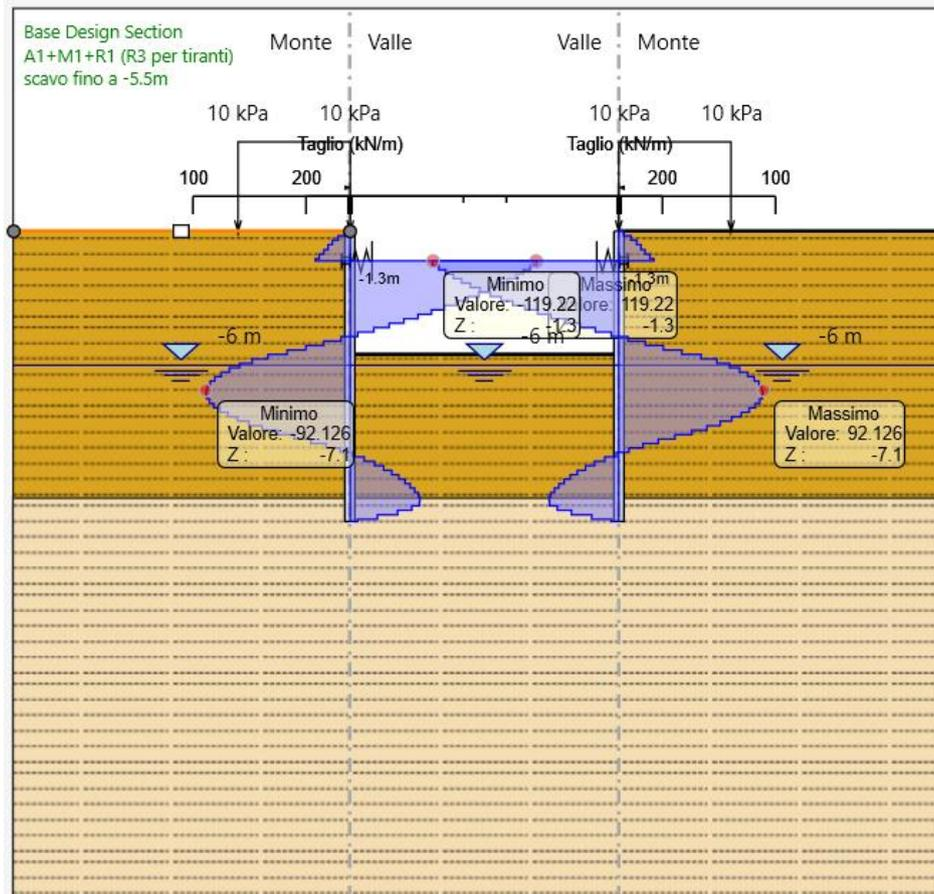
Nel seguito si riportano i risultati delle verifiche strutturali delle palancole metalliche a flessione e a taglio condotte mediante l'ausilio di Paratie plus. In Particolare si riportano i diagrammi dei tassi di sfruttamento sul palo, ottenuti come rapporto tra sollecitazione presente e resistenza disponibile in ogni sezione del palo.
