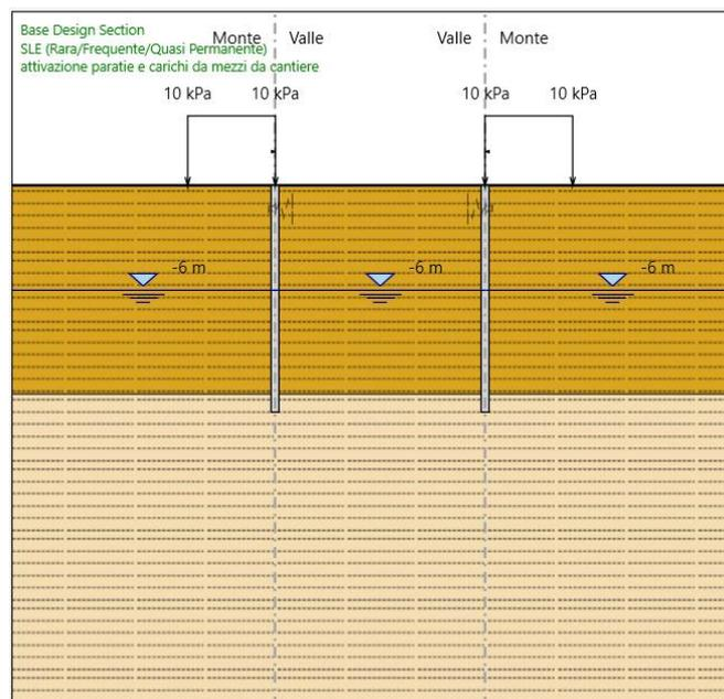
**FASE 1: Installazione delle paratie di pali + attivazione carico di cantiere qacc=10.0 kPa**
