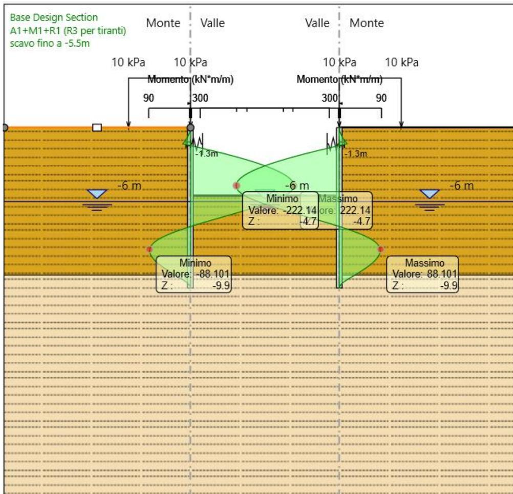
Dall'involuppo del taglio in combinazione A1+M1+R1 si osserva che il massimo valore sulla paratia di destra e di sinistra si ha ad una quota di 1.3 m da testa palo e risulta pari a 119.22 kN/m,
