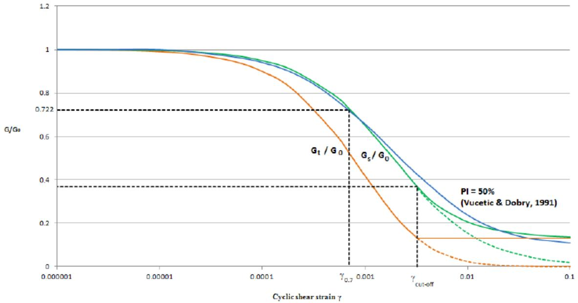
Figura 17. Curva di riduzione del modulo  $G$
