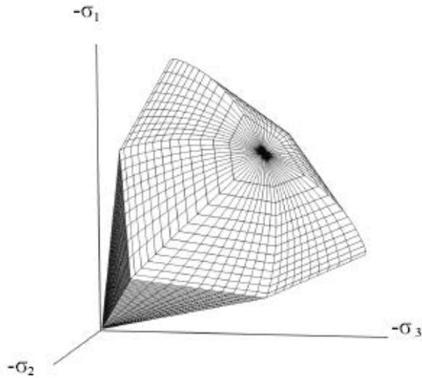
Figura 13. Superficie di snervamento chiusa (Hardening Soil model)
