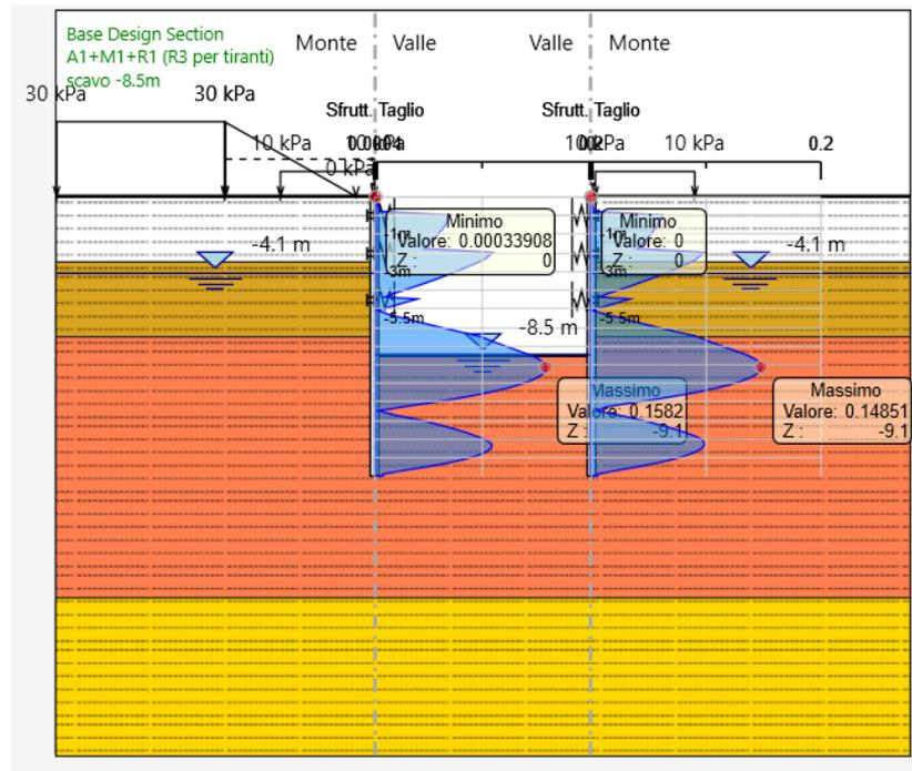
Tasso di sfruttamento a taglio dell'armatura in comb. A1-M1-R3 (.T.S.F.<sub>max</sub> = 0.16 < 1 – VERIFICA SODDISFATTA)
