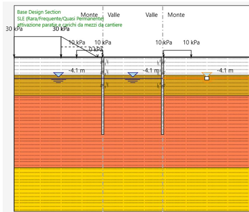
**FASE 1: Installazione palancole metalliche + attivazione carico di cantiere  $q_{acc}=10.0$  kPa +attivazione carico trapezoidale che simula il terreno**
