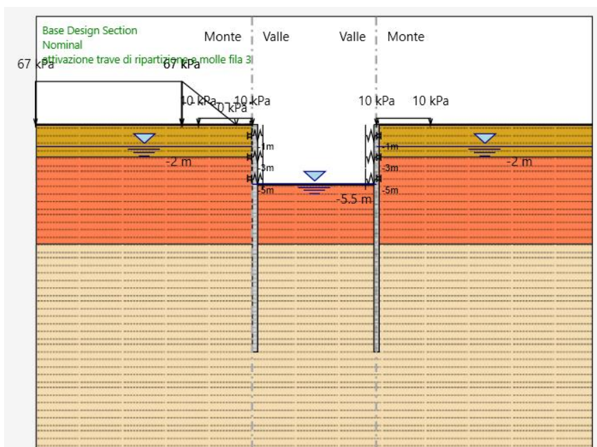
FASE 8: Installazione dei puntoni, con relative travi di ripartizione dei carichi, a 5 metri dalla testa della paratia
