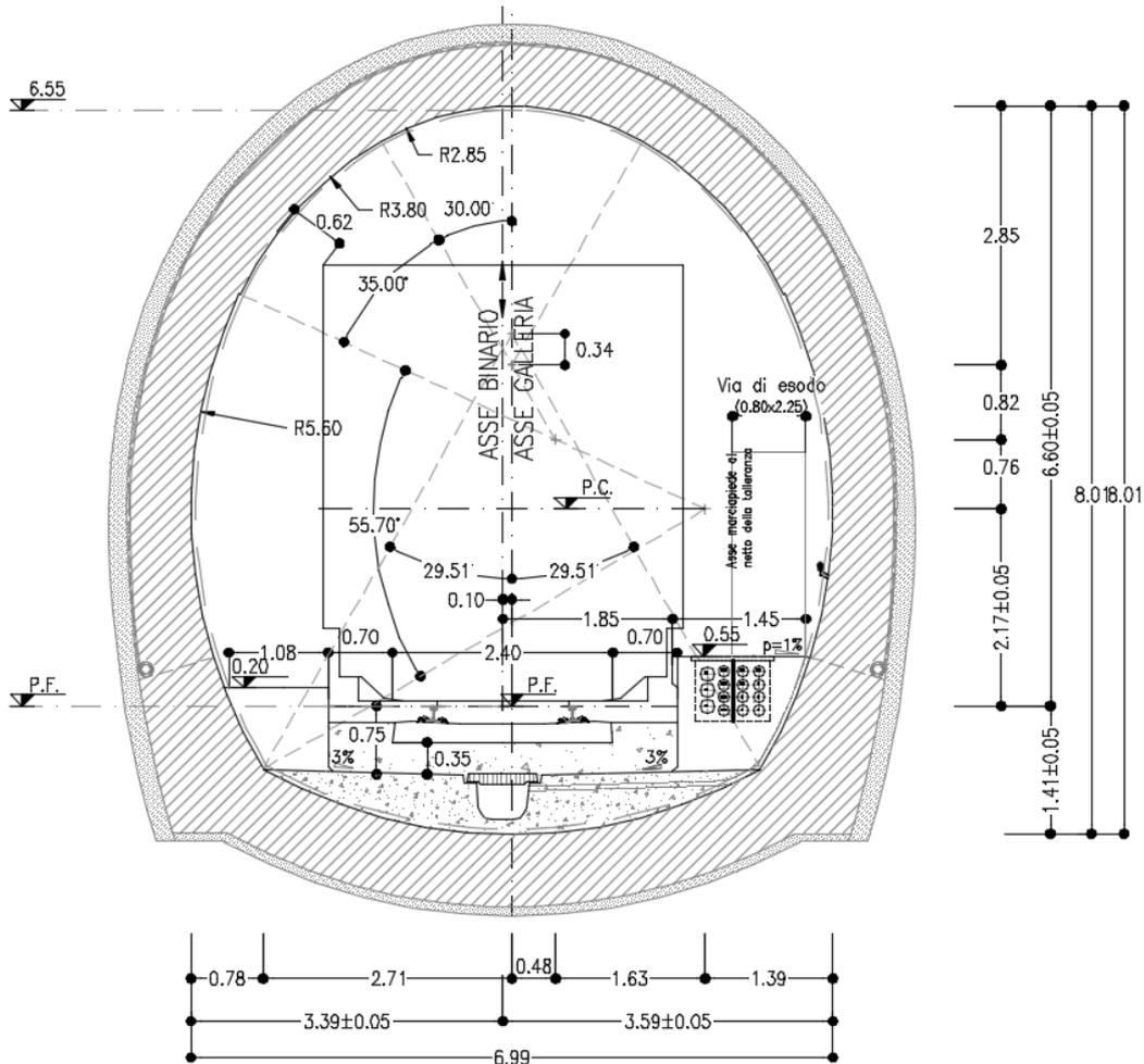
La galleria Salvatore a doppio binario ha sia sezione policentrica sia sezione scatolare (tratto di galleria artificiale di imbocco lato Catania). La configurazione policentrica presenta un raggio di 5,40 m per calotta e piedritti. Tale sezione sviluppa un'area libera di poco superiore ai 66 m<sup>2</sup> e un perimetro pari a circa 32 metri, come previsto dal Manuale di Progettazione RFI.
