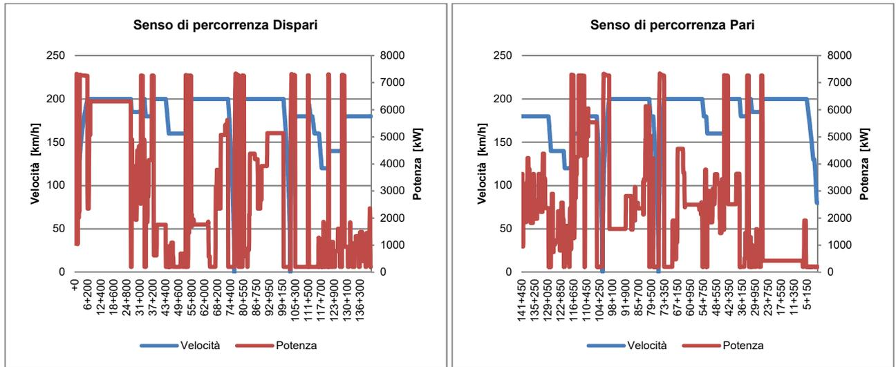
Figura 5 – Lunga Percorrenza "E402B" – Diagrammi Spazio/Velocità - Spazio/Potenza
