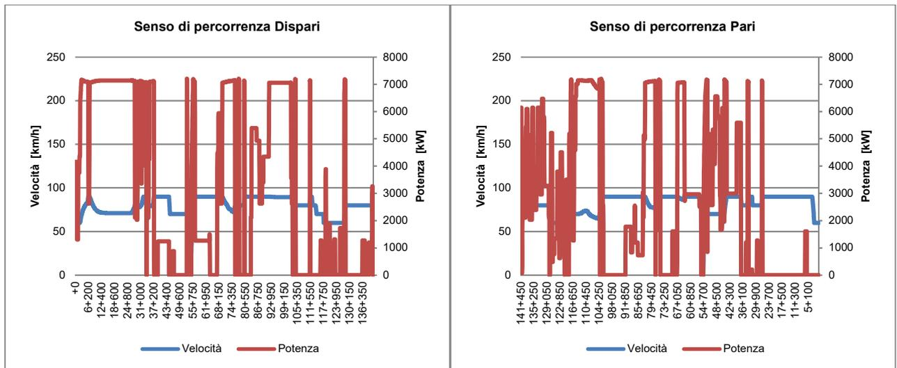
Figura 6 – Mercì "E186" – Diagrammi Spazio/Velocità - Spazio/Potenza
