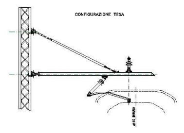
La sospensione è costituita da una mensola orizzontale in alluminio sostenuta da un tirante inclinato: entrambi sono collegati al sostegno per mezzo di attacchi a cerniera che permettono la libera rotazione della sospensione sul piano orizzontale al fine di consentirne il movimento longitudinale dei conduttori regolati automaticamente.
