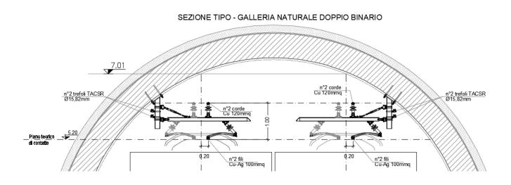
Le grappe in acciaio per il fissaggio dei supporti penduli saranno ancorate alla volta con l'impiego di aggrappanti chimici, ed isolate dal possibile contatto con l'armatura delle strutture mediante l'impiego di opportune boccole distanziali in materiale isolante.
