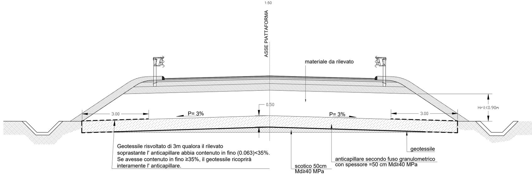
SEZIONE TIPO IN RILEVATO -  $0.90m < H_{rili} \leq 1.10m$
