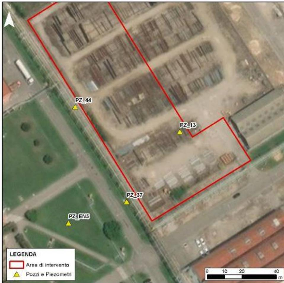
**Figura 7.6.5: Mappa dei pozzi e dei piezometri da monitorare all'interno dello stabilimento**
