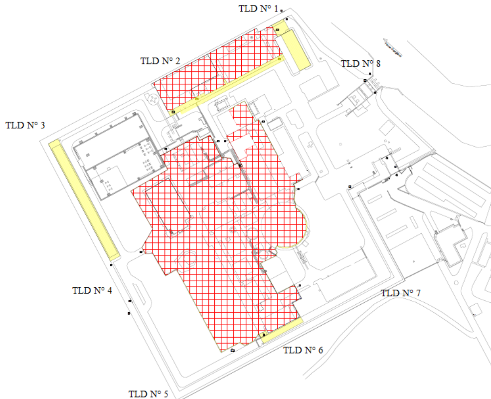
Figura n.1 - Ubicazione dosimetri - Recinzione Impianto
