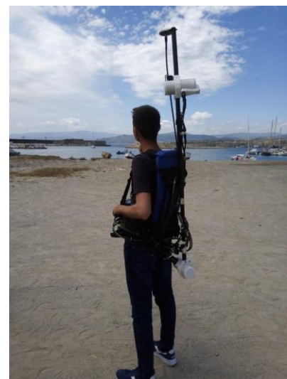
Figura 13. Profili realizzati durante l'indagine magnetometrica - Operatore durante a fase di acquisizione
