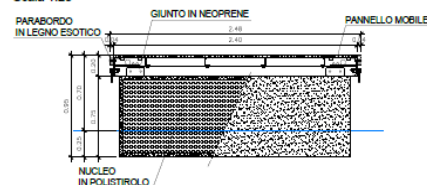
Figura 24 Pianta, vista laterale e trasversale tipologia dei pontili. Estratto dalla tavola B15
