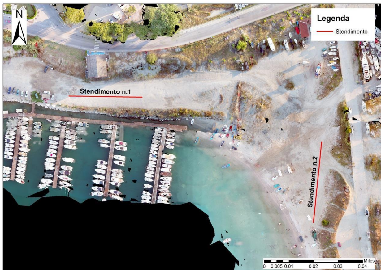
Figura 20 Ubicazione degli stendimenti sismici
