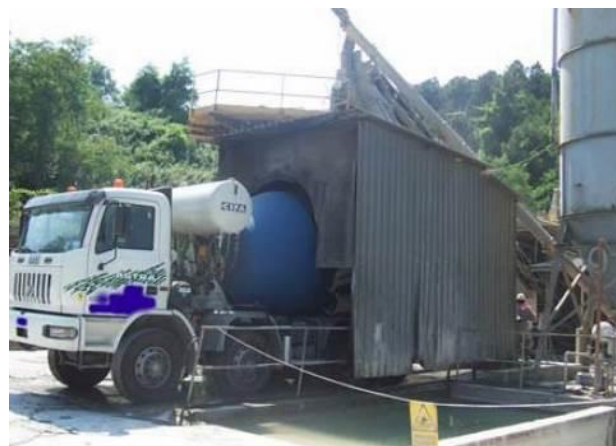
Esempi di confinamenti potenzialmente presenti in un impianto di betonaggio
