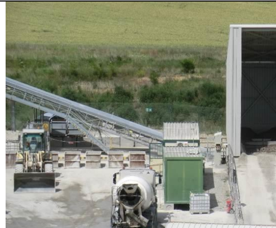
Nastro estrattore-sollevatore protetto sia sommitalmente sia lateralmente. E' inoltre dotato di una struttura inferiore per la raccolta delle perdite
