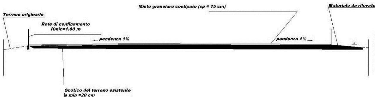
FIGURA 2.4-6 – PARTICOLARE DELLA PAVIMENTAZIONE DELLE AREE DI CANTIERE
