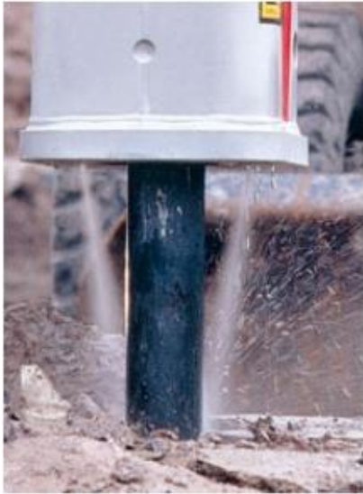
Martelloni: ugelli di solid stream al punto di sollecitazione del materiale
