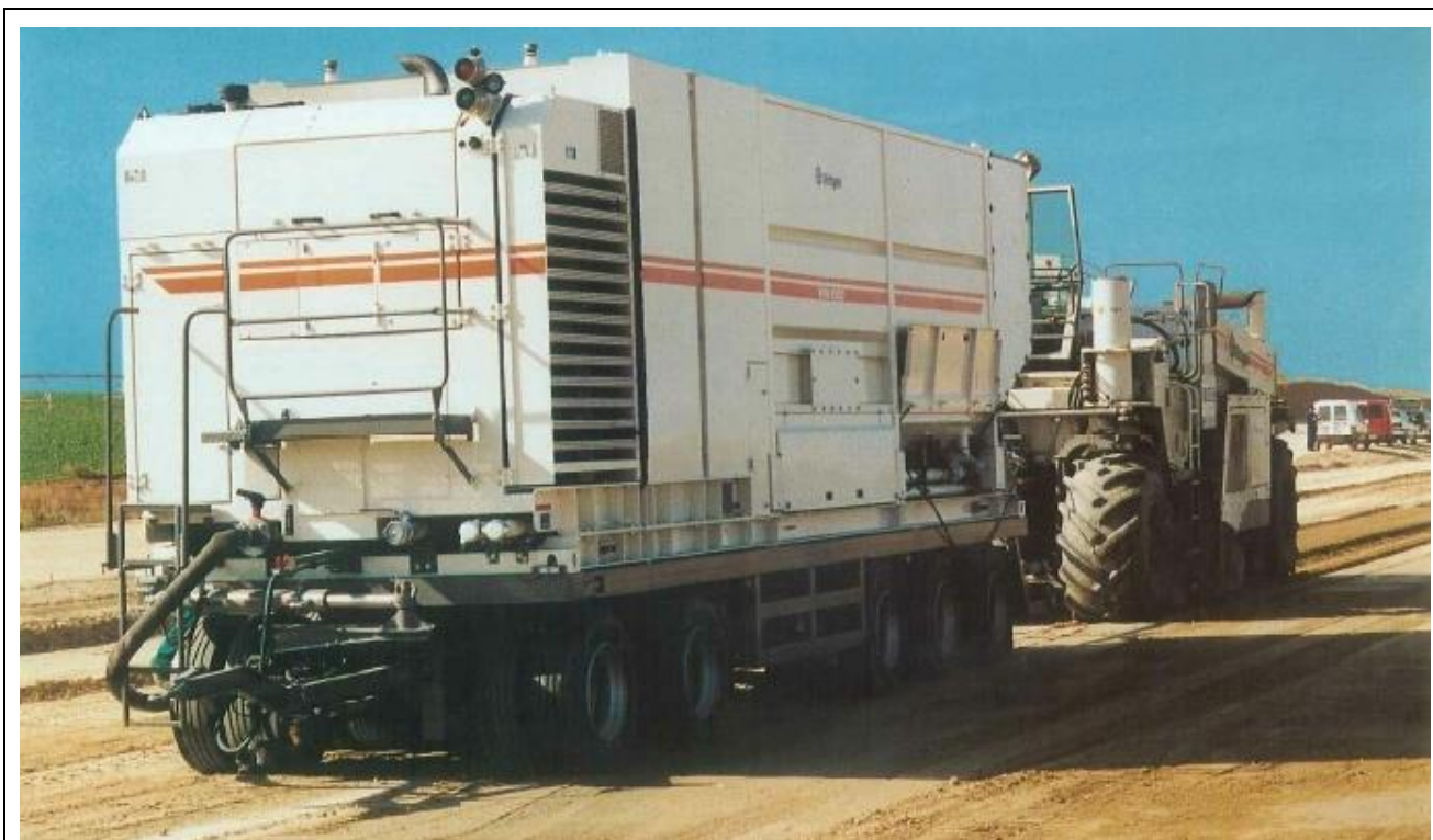
FIGURA 10.3-18: MACCHINARIO UTILIZZABILE PER LA STABILIZZAZIONE DI RILEVATI CON SOSPENSIONI DI ACQUA E STABILIZZANTE
