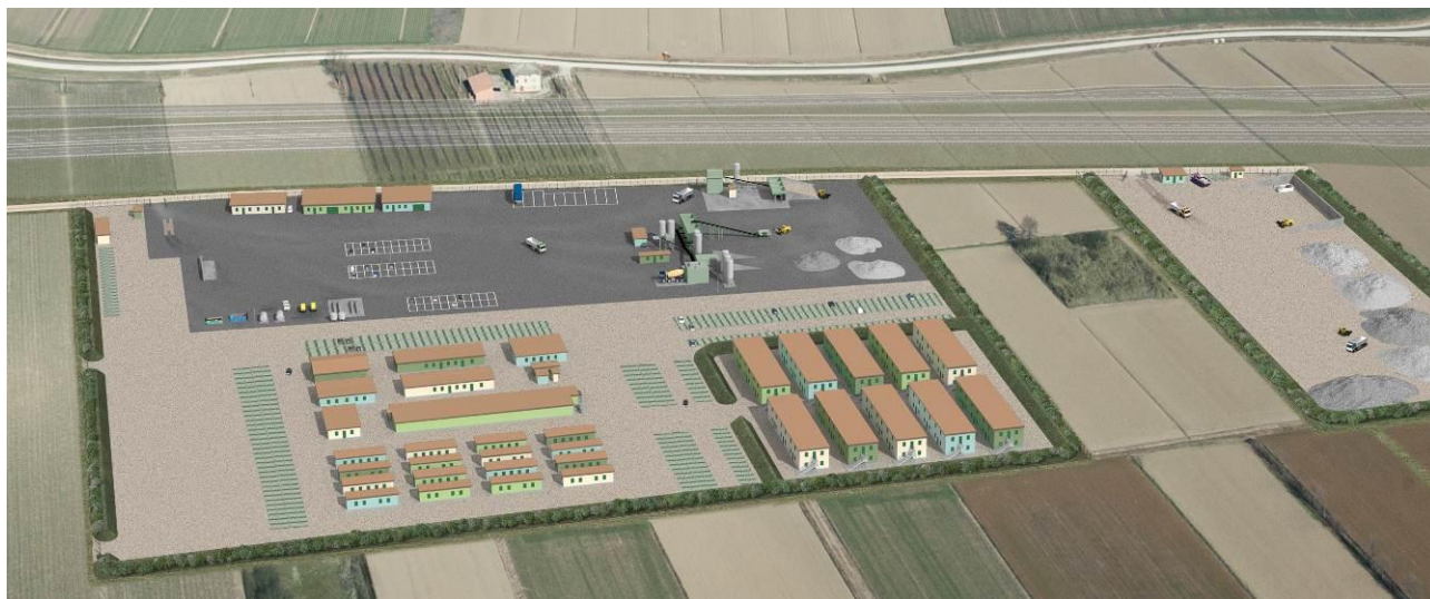
FIGURA 10.6-3 – CANTIERE 2-B.1 SIMULAZIONE A VOLO D'UCCELLO CON LE OPERE DI MITIGAZIONE PREVISTE: DUNA, SIEPE ARBUSTIVA E PIGMENTAZIONE DEGLI EDIFICI DI CANTIERE SECONDO LE CROMIE PREVALENTI (AMBITO FLUVIALE)
