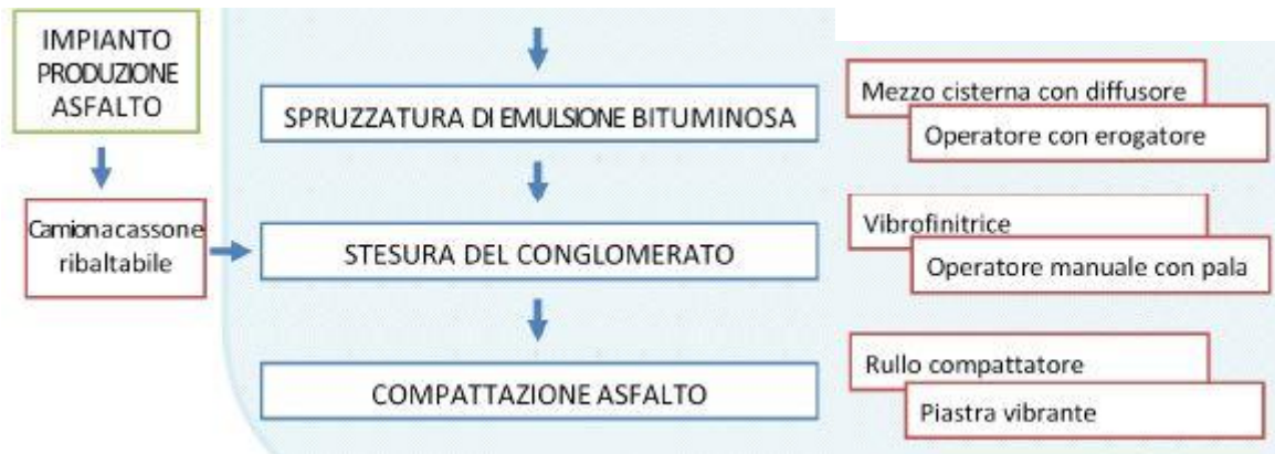
FIGURA 5.1-1 – FLOW CHART OPERAZIONI DI ASFALTATURA (FONTE: ISPESL DIPARTIMENTO DOCUMENTAZIONE, FORMAZIONE, INFORMAZIONE - - B1/N°2/DOC/05 -I PROFILI DI RISCHIO NEI COMPARTI PRODUTTIVI DELL'ARTIGIANATO, DELLE PICCOLE E MEDIE INDUSTRIE E PUBBLICI ESERCIZI: ASFALTATORI – MARZO 2009)
