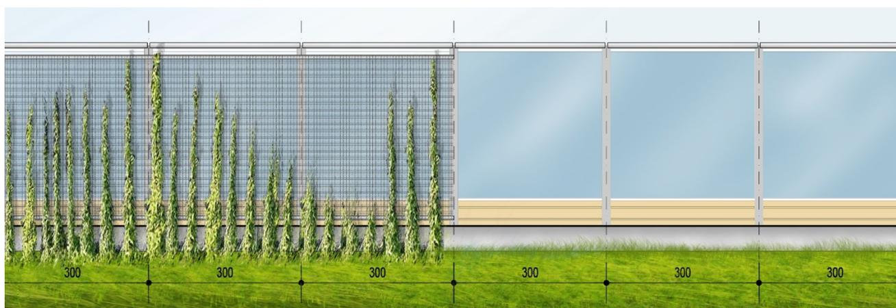
**FIGURA 7-10 – BARRIERA ACUSTICA FONOIOLANTE TRASPARENTE – PROSPETTO LATO RICETTORE**
