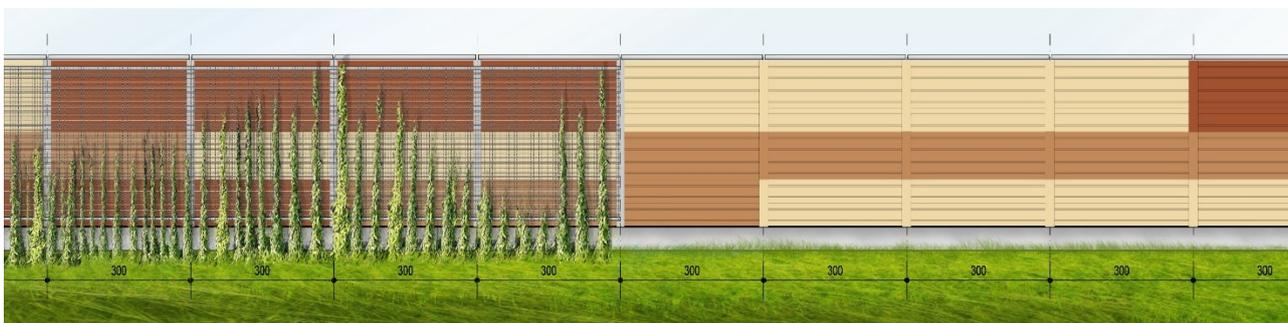
**FIGURA 7-4 – BARRIERA ACUSTICA OPACA FONOASSORBENTE SU RILEVATO – VISTA PROSPETTICA LATO RICETTORE**
