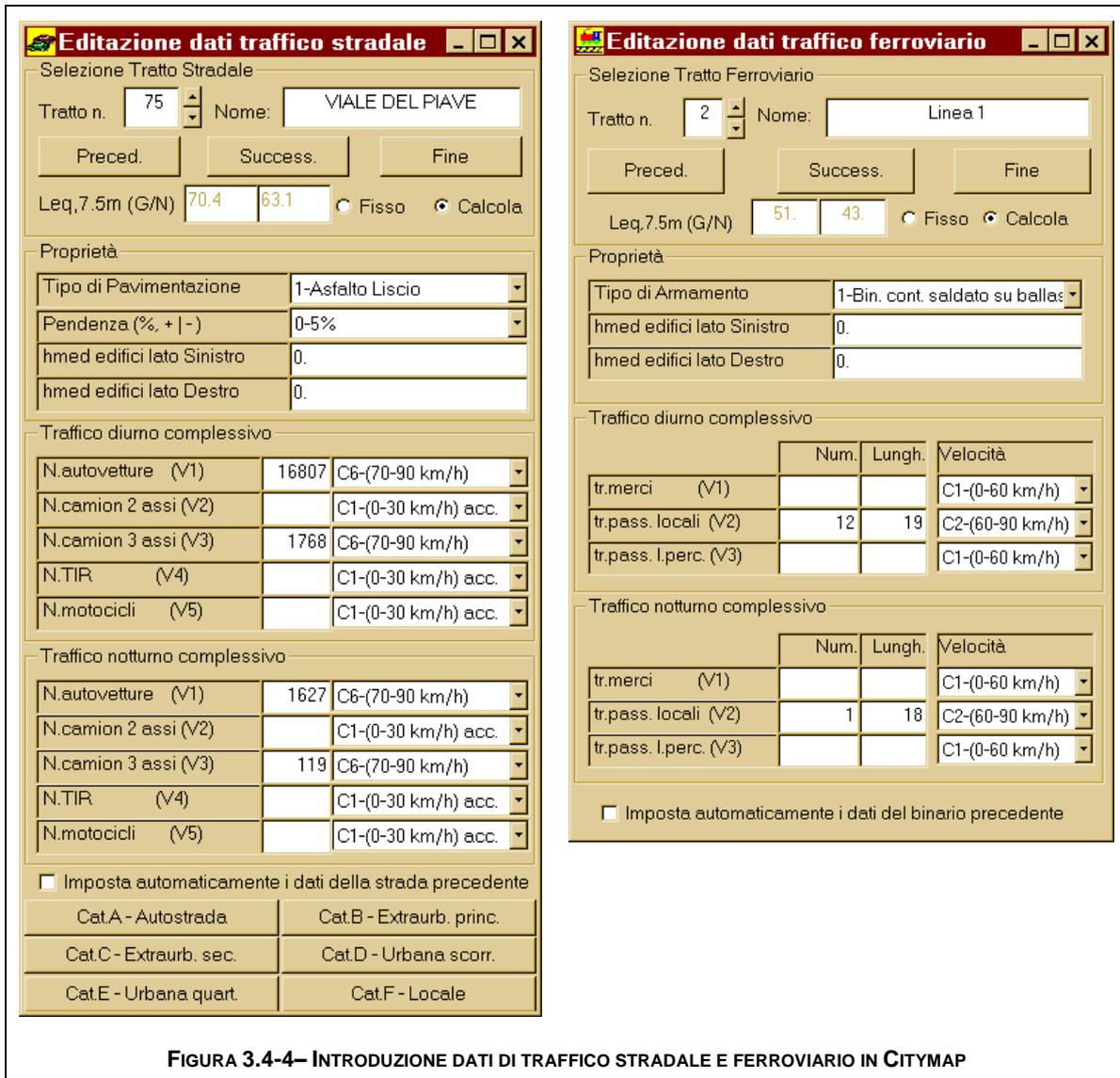
FIGURA 3.4-4– INTRODUZIONE DATI DI TRAFFICO STRADALE E FERROVIARIO IN CITYMAP
