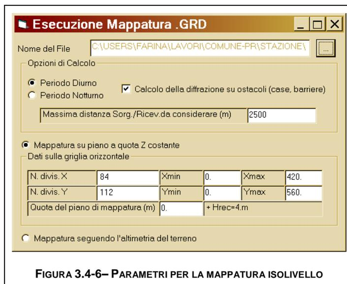
**FIGURA 3.4-6– PARAMETRI PER LA MAPPATURA ISOLIVELLO**
