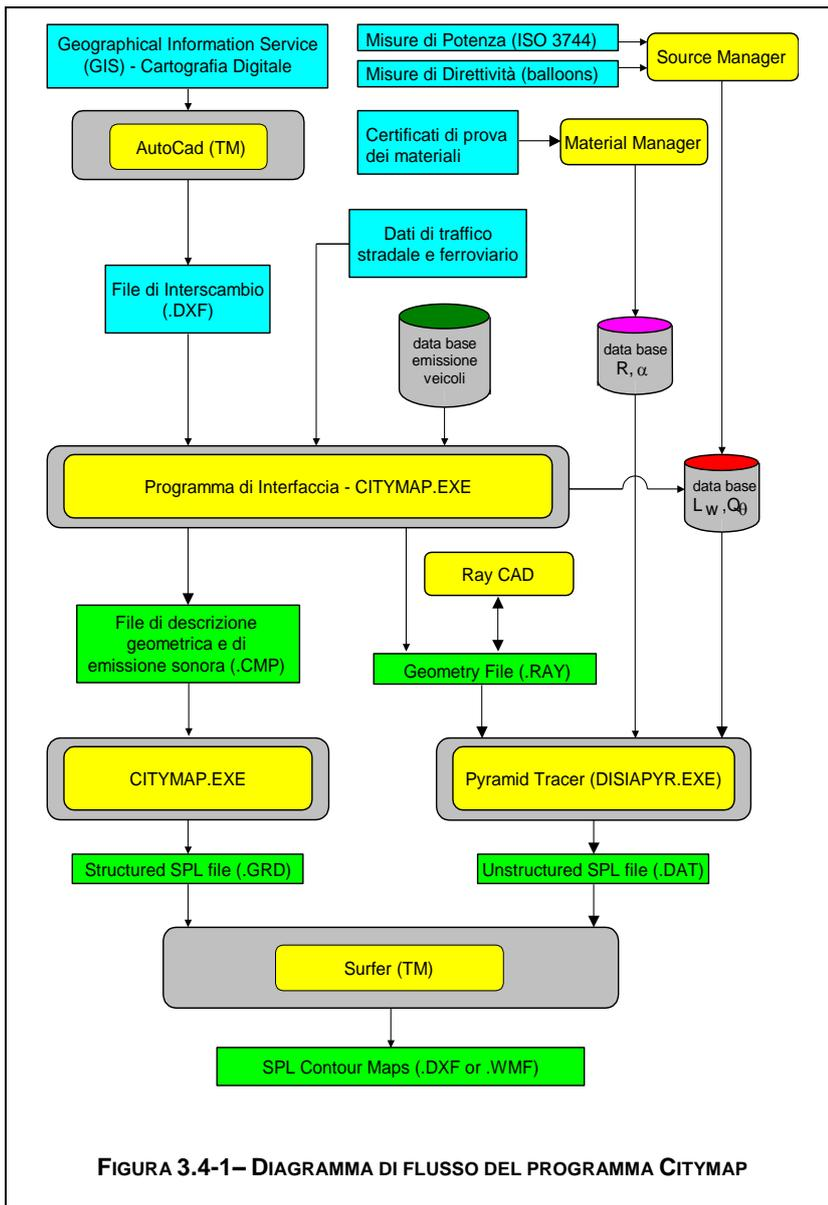
Come si nota numerosi programmi sono chiamati ad interagire: di essi due sono programmi commerciali (Autocad™ e Surfer™), mentre gli altri sono stati realizzati in proprio.
