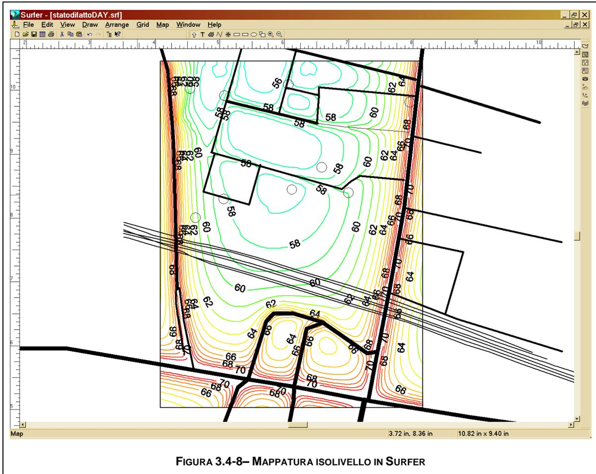
Da Surfer, infine, si può esportare l'assieme delle curve isolivello, in formato vettoriale. Esse possono poi venire re-importate in Autocad, realizzando quindi in tale ambiente la tavola finale, che mostra la mappa del rumore sovrapposta allo sfondo cartografico dettagliato di partenza.
