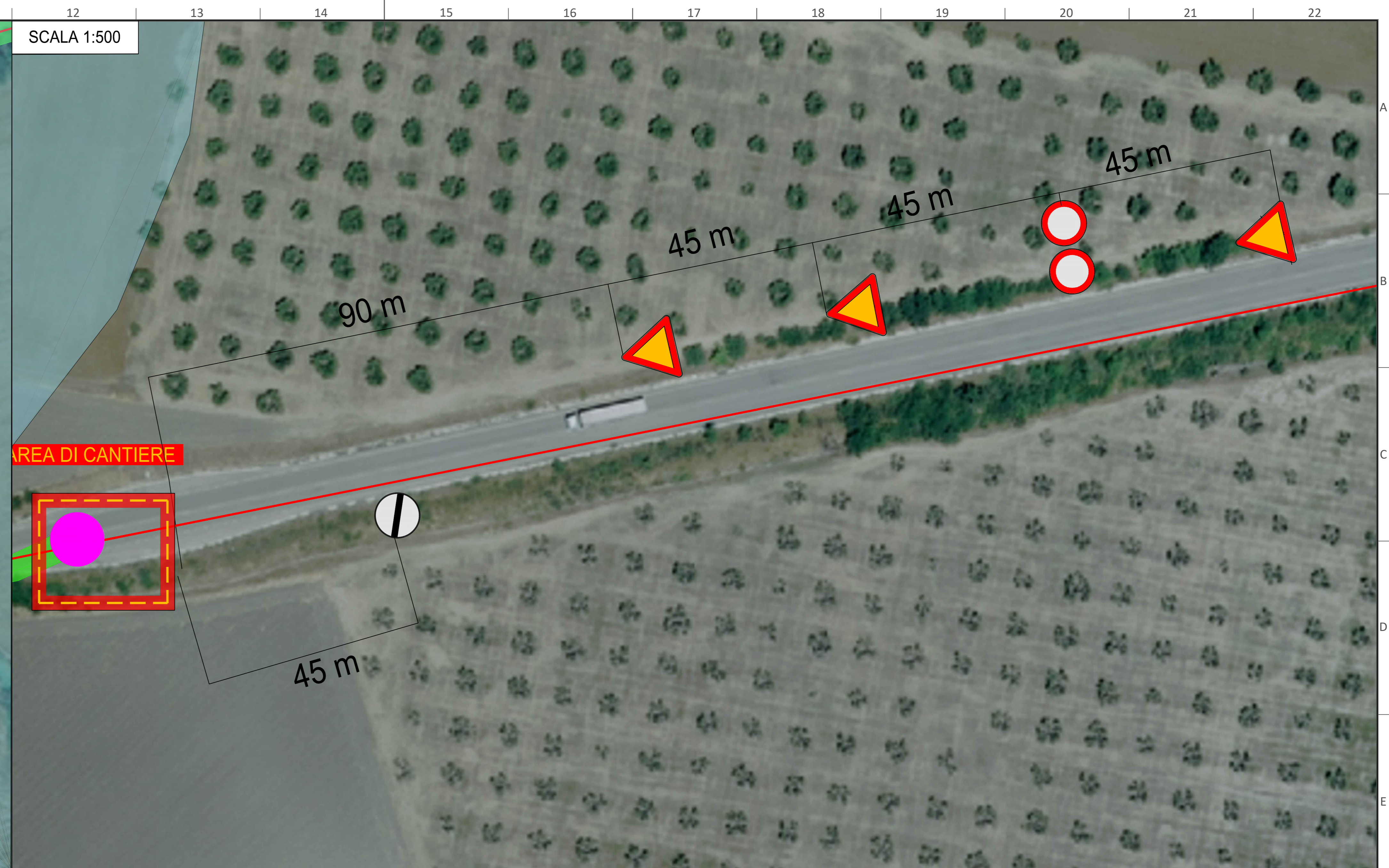
PARTICOLARE SU ORTOFOTO DELL'AREA DI CANTIERE DEL FORO IN USCITA DELLA T.O.C. VALLONE CATAPANE E SEGNALETICA DI CANTIERE
