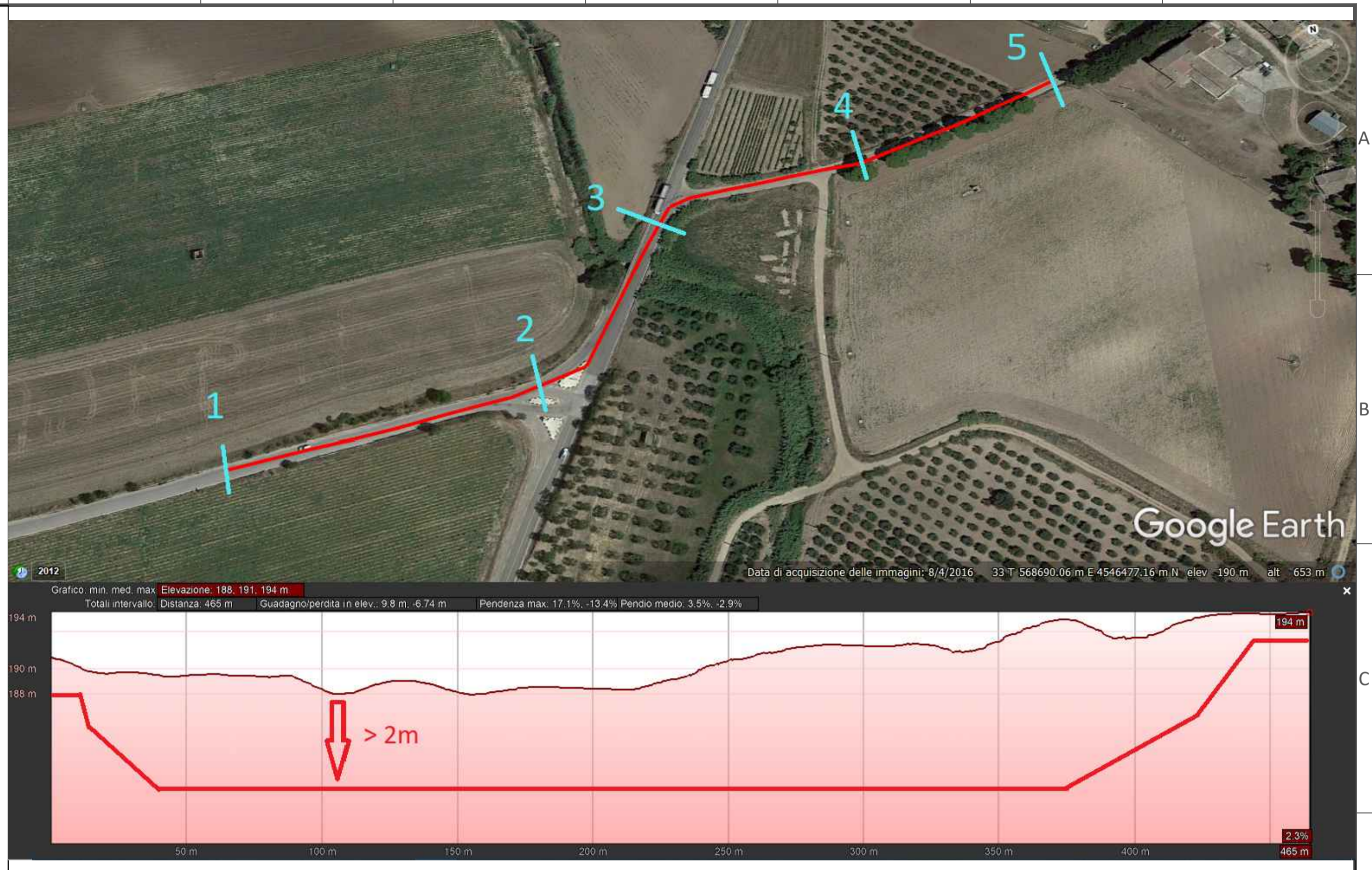
STRALCIO DEL PROFILO LONGITUDINALE DELLA T.O.C. TORRENTE CRAPELLOTTO
