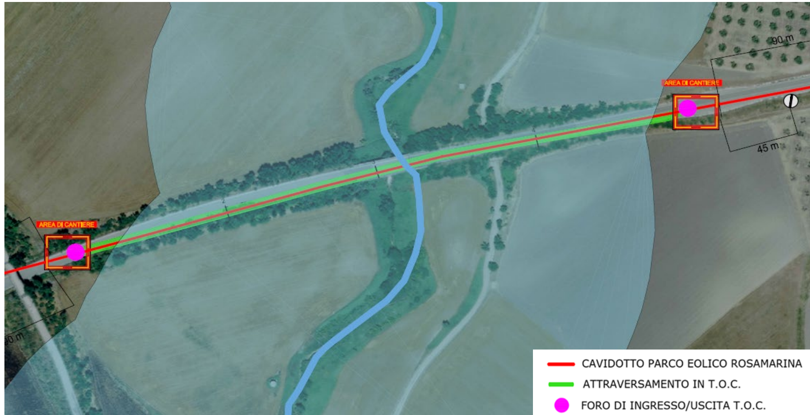
Figura 16 – Stralcio planimetrico su ortofoto con indicazione del tratto di cavidotto da realizzare in T.O.C in corrispondenza del Vallone di Catapane
